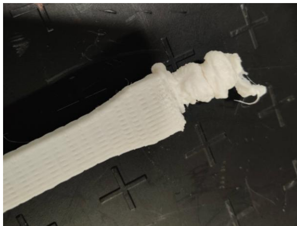
Figura 49: Imatge d'un defecte d'impressió de les provetes.
