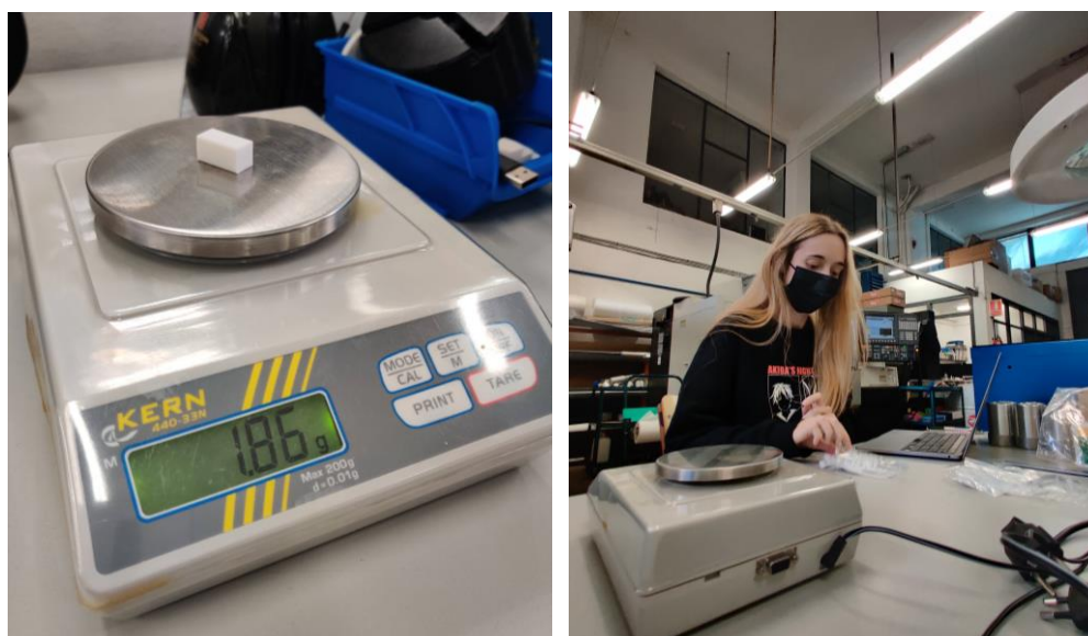
Figura 12: Imatges de la presa de dades per tal de calcular la densitat real.
