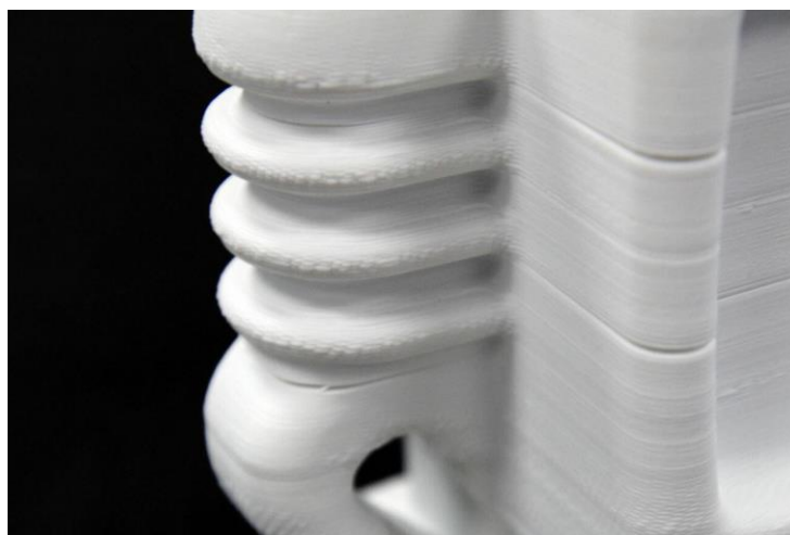
Figura 45: Imatge d'exemple de la delaminació en impressió 3D.
