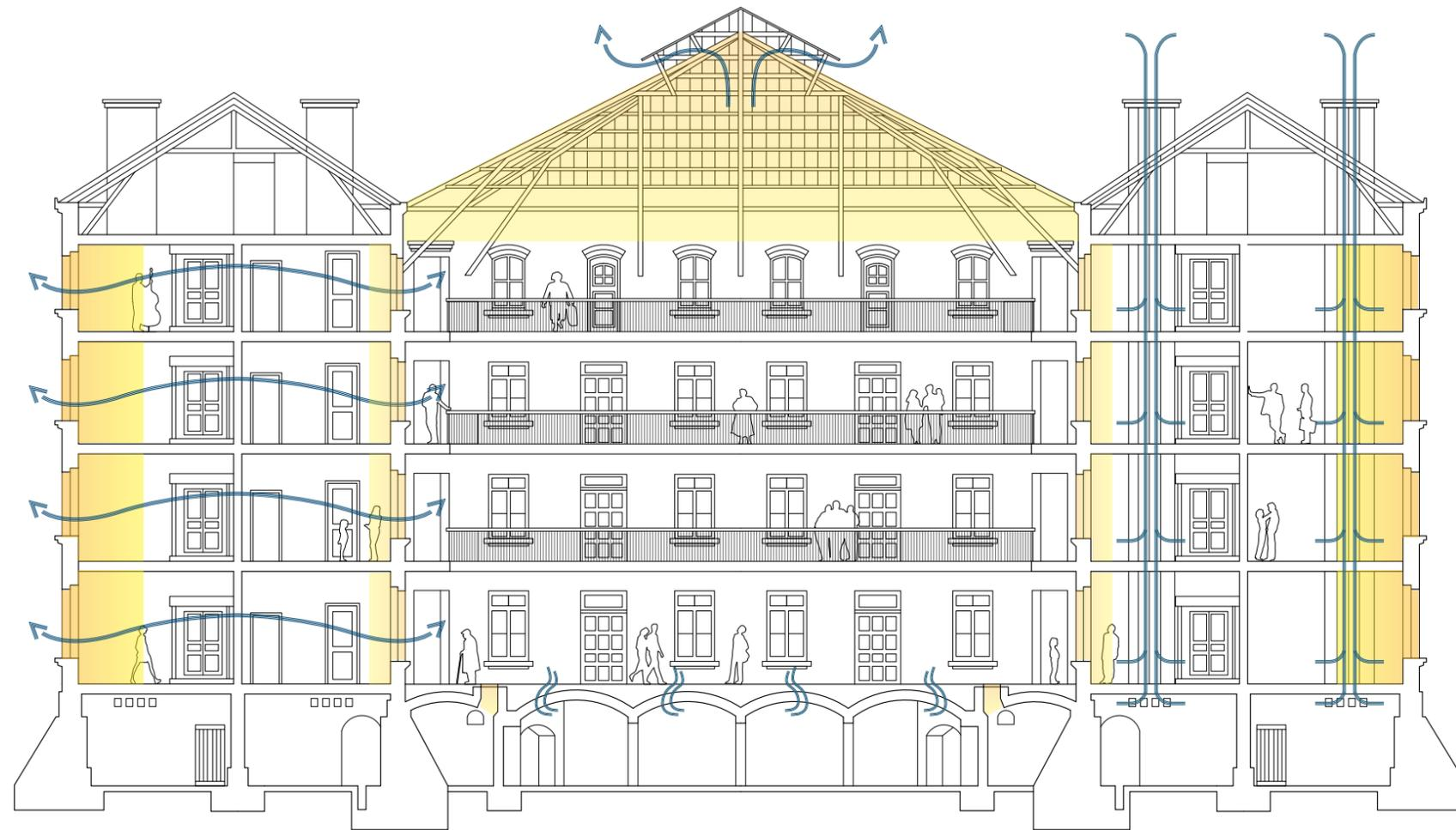
fig 46. Sección transversal del pabellón central y estrategias climáticas. Fuente: Elaboración propia.
