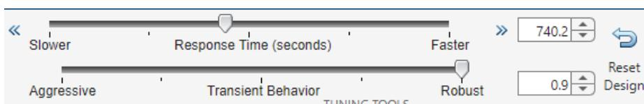
Imagen 5. Evidencia de herramienta manual para establecimiento de niveles de rapidez y robusteza que se desean en el diseño de control en Simulink PID Tuner. Tomado de Interfaz de Simulink PID Tuner
