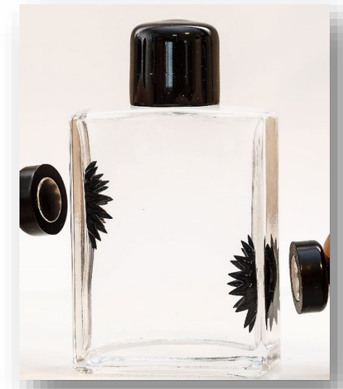
Figura 79. Flasc de vidre, ferrofluid dissolt en salmorra – Font: pròpia.
