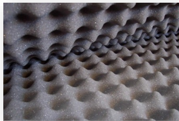
Figura 20. Escuma acústica de l'interior d'un altaveu - Font: [5]
