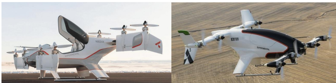
Figura 10: Airbus Vahana, a la izquierda, con las alas en posición de despegue y aterrizaje. A la derecha, en pleno vuelo. Fuente: Airbus
