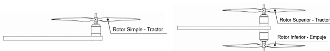
Figura 20: configuración rotor simple vs rotor coaxial. Fuente: elaboración propia
