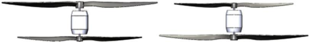
Figura 21: configuración rotores coaxiales con diferente diámetro de hélice. Fuente: Research Gate
