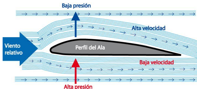
Figura 25: fuerza de sustentación provocada por el efecto Bernoulli sobre el ala de un avión. Fuente: Research Gate [8]
