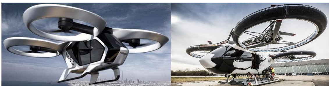
Figura 12: el City Airbus. A la izquierda, el concepto inicial. A la derecha, el modelo real que ha realizado el primer vuelo. Fuente: Airbus
