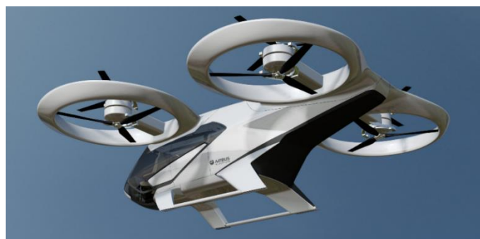
Figura 26: rotores protegidos en el City Airbus. Fuente: Airbus
