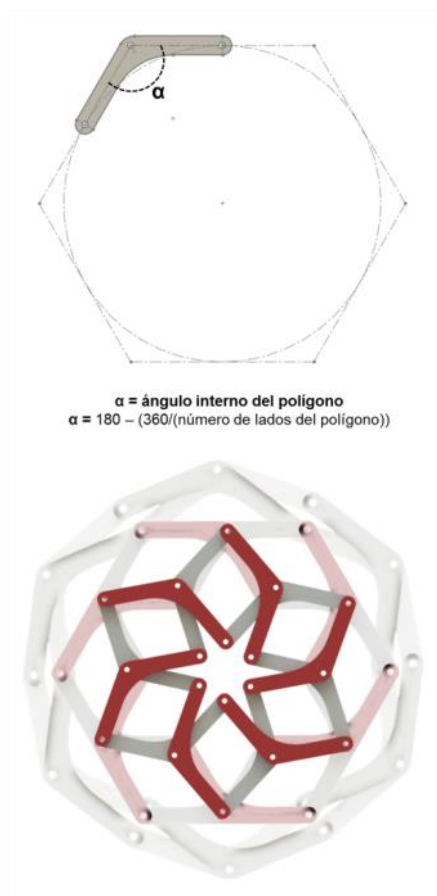
Figura 3.5 Hexágono desplegable a partir de barras anguladas.
