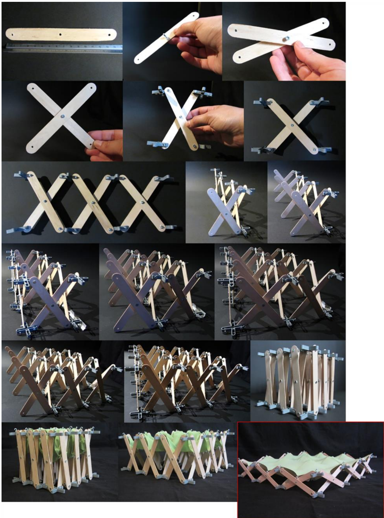
Figura 3.25 Secuencia de imágenes del paso a paso para el armado de una estructura desplegable con el STT. Agrupación de tijeras rectas con articulación central, red cuadrangular. Despliegue lineal. Materiales: Barras en madera (Palos de helado o bajalenguas), separadores plásticos para cerámica tipo cruz (nodos), tornillos, tuercas y manguera plástica (separador entre barras, diámetro un poco mayor al del tornillo). Maqueta realizada con simple capa de tijeras, las siguientes maquetas se elaboran con doble capa de tijeras para mejorar la estabilidad, resistencia y durabilidad de la maqueta. Fuente: Workshop ETSAV 2013-2016. Modelos y fotografías realizados por Annamaria Patiño Lakatos. https://smia-experimental.com/ Recuperado [10/01/2019]
