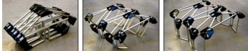
Figura 2.100 Proceso de despliegue estructura barras articuladas [19].
