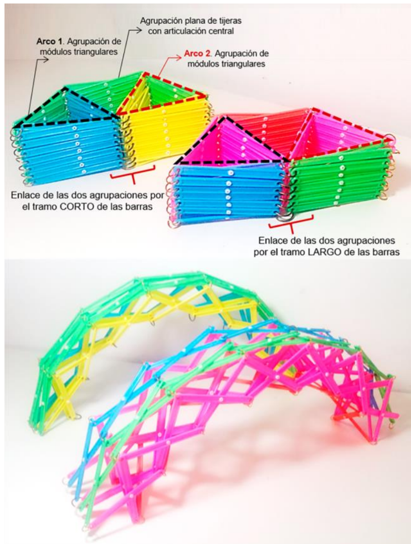
Figura 3.50 Maquetas con barras plásticas y nodos a partir de anillas metálicas. Configuración superficie con simple curvatura. Dos propuestas diferentes de enlazar dos arcos formados por módulos triangulares.
