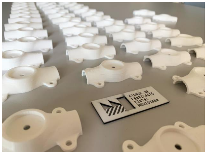
Figura 10.67 Proceso de impresión 3D. Abrazaderas y nodo principal. Fuente: Elaboración del autor
