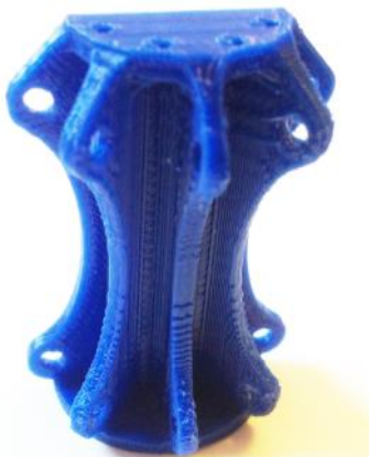
Figura 7.22 Propuesta de nodo 2. Impresión 3D, material PLA.
