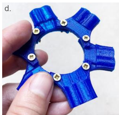
Figura 7.38 Propuesta nodo 5. a) Proyección encaje de pletinas en barras que conforman el nodo, parte inferior. b) Acoplamiento de pletinas. c) Modelado digital pletinas parte superior e inferior. d) Modelo de nodo realizado con impresión 3D.
