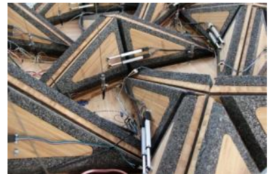
Figura 2.119 Mecanismo de pistones para el plegado del panel [16]
