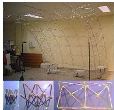
Figura 2.31 Sistemas de diagonalización progresiva en módulos cuadrados, aplicados en un tornavoz transportable para un escenario [25]
