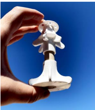
Figura 7.50 Propuesta de nodo 4. Impresión 3D, material PLA. Para domo en bambú. Fuente: Elaboración del autor
