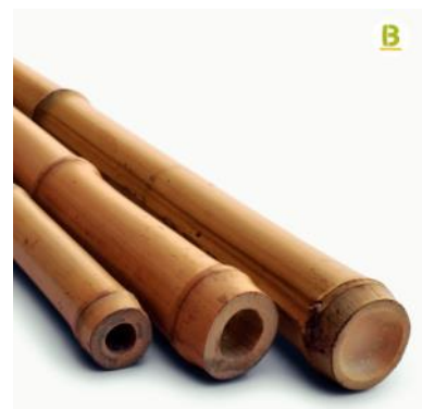
Figura 10.66 Barra de bambú del tipo Tonkin Ø15 mm. Espesor de pared de 3 a 4 mm [103]
