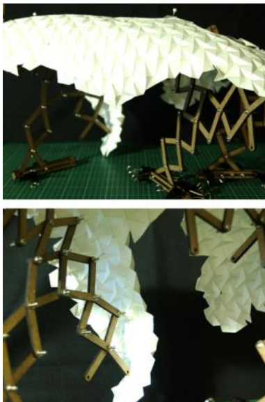
Figura 2.88 Maqueta combinada de origami y sistema tipo tijera. Daniel MacGibbon. Fuente https://hiveminer.com/Tags/hoberman.origamiFigura Recuperado [15/05/2018]
