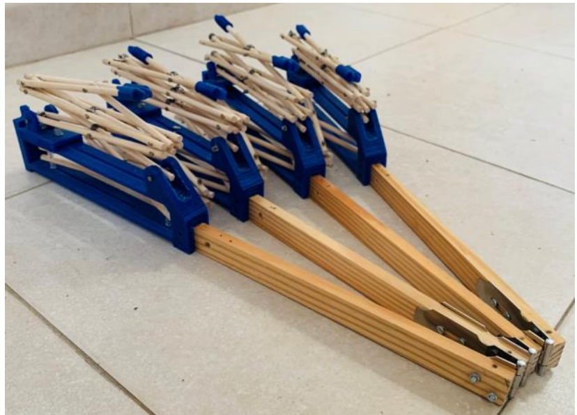
Figura 8.26 Maqueta de medio domo desplegable. Detalle bisagras para articular las vigas soporte y generar el movimiento abatible de la estructura de la plataforma Fuente: Elaboración del autor
