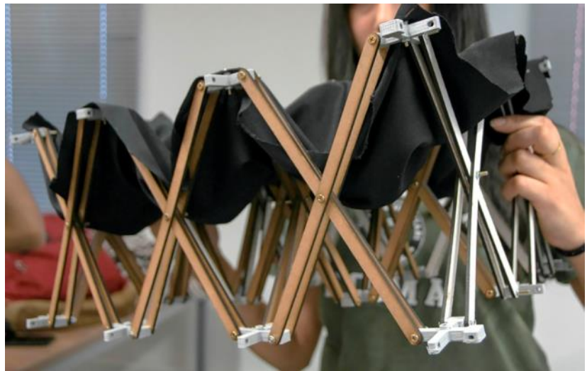
Figura 3.26 Agrupación de tijeras rectas con articulación central. Despliegue lineal. Red cuadrangular. Barras en MDF realizadas con corte laser. Nodo en PLA, impresión 3D. Conexiones entre elementos a través de tornillos y asegurados con tuercas. Propuesta de cubierta desplegable en lycra. Fuente: Elaboración del autor. Workshop Pontificia Universidad Católica de Minas Gerais, Brasil. 2017
