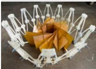
Figura 2.126 Solar Power. Etapa final e inicial de plegado [50].
