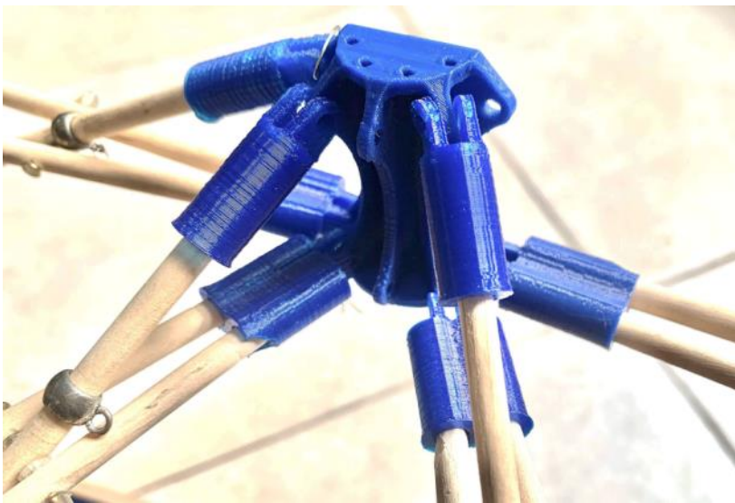
Figura 7.23 Detalle ensamble de nodo 2 y semiarcos en maqueta. Fuente: Elaboración del autor
