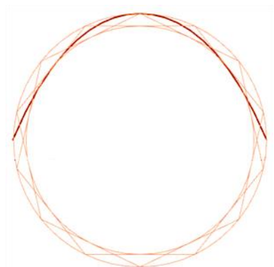
Figura 5.29 Principio de la catenaria invertida para establecer el espesor de arcos (Heyman 1999, como se cito en Huerta [43]) proyectado en un polígono estrellado, que configura una agrupación de tijeras rectas para formar arcos desplegables.
