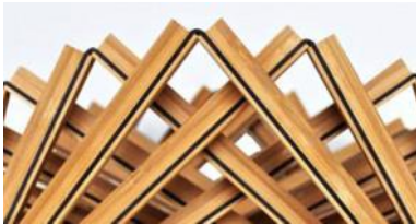
Figura 2.124 Bisagra flexible. Caucho entre las laminas de bambú. Fuente: www.facebook.com/pg/robertvanembricqs/photos/ Recuperado [15/07/2018]
