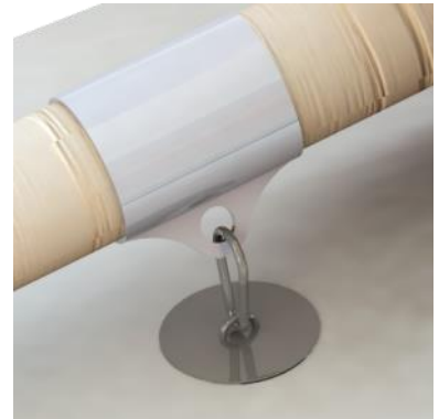
Figura 9.26 Izquierda: Plano detalle sujeción cubierta interior con abrazadera, pletina y mosquetón.
