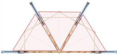
Figura 8.13 Geometría plegadura de suelo a partir de triángulos equiláteros Fuente: Elaboración del autor
