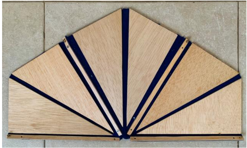
Figura 8.31 Maqueta de medio domo desplegable. Configuración de la plataforma plegable con paneles de madera. Se incluye un listón de madera adicional alineado con las vigas para atornillar la plataforma a la estructura soporte (vigas).
