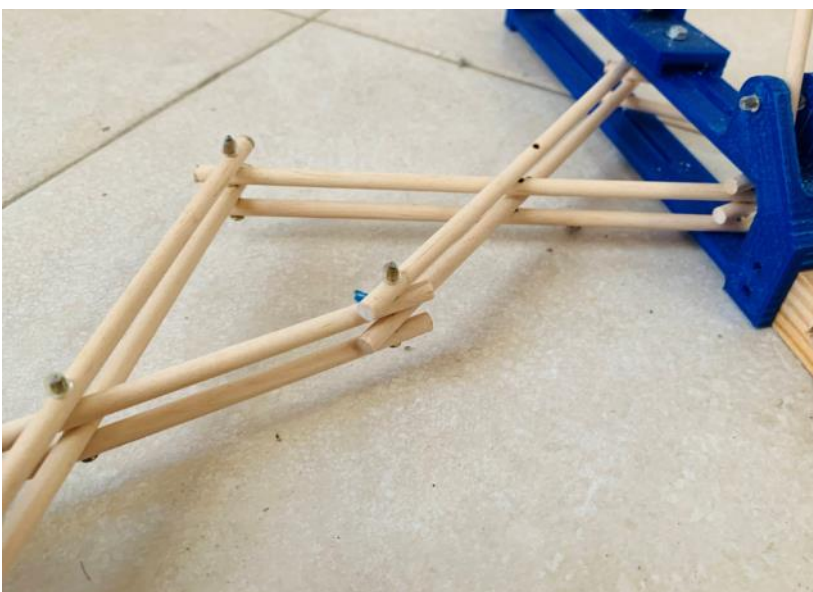
Figura 8.30 Maqueta de medio domo desplegable. Detalle desarticulación central de tijeras de suelo Fuente: Elaboración del autor
