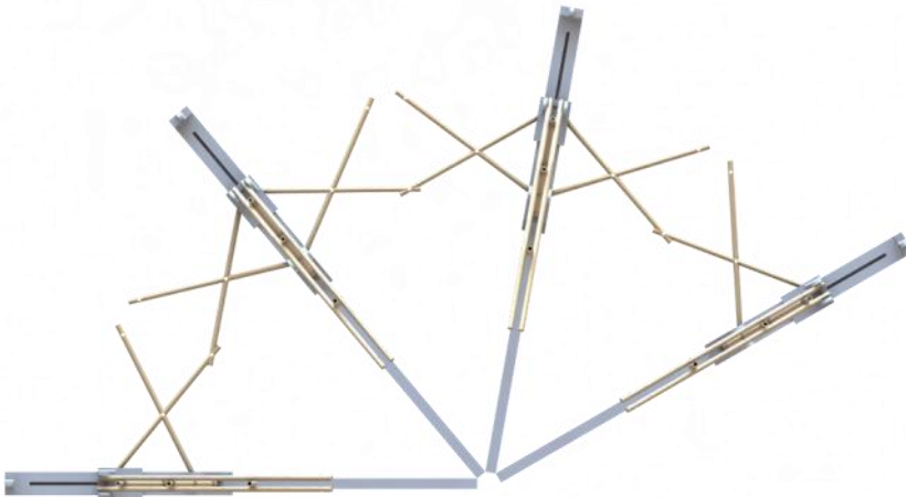
Figura 8.7 Agrupación de tijeras de suelo. Proceso de despliegue con curvatura constante. Desarticulación de los tramos largos entre tijeras adyacentes, donde no coinciden con un semiarco. Simulación SolidWorks® [135] Fuente: Elaboración del autor
