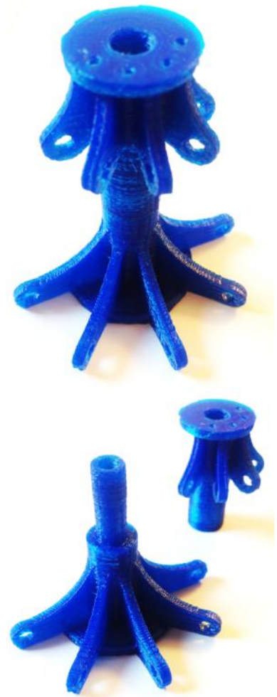
Figura 7.27 Propuesta de nodo 3. Impresión 3D, material PLA. Fuente: Elaboración del autor
