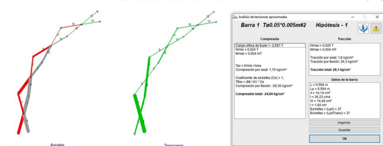
Figura 6.51 Representación de los axiales y las tensiones aproximadas compresión y tracción). Semiarco en posición ideal. Simulación en dos dimensiones realizada con WinEva8 © [136].
