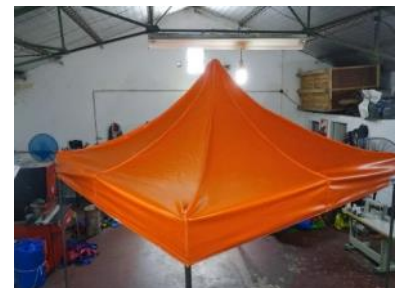
Figura 1.16 Cubierta con arrugas y posibles embolsamientos de agua
