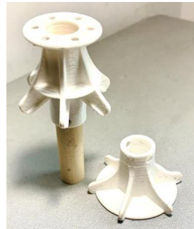
Figura 7.34 Propuesta de nodo 4. Impresión 3D, material PLA. Fuente: Elaboración del autor
