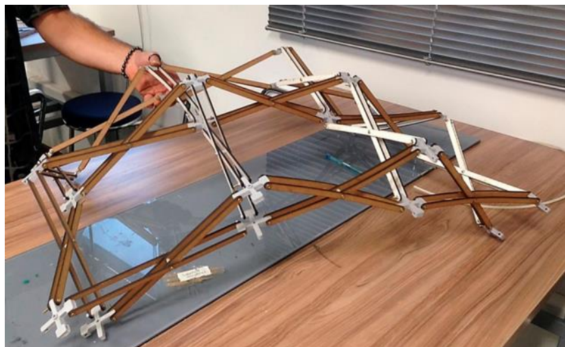
Figura 3.70 Maqueta. Agrupación de tijeras rectas con articulación excéntrica. Red cuadrangular. Superficie anticlástica. Nodo en PLA, Workshop Pontificia Universidad Católica de Minas Gerais, Brasil. 2017. Fuente: Elaboración del autor
