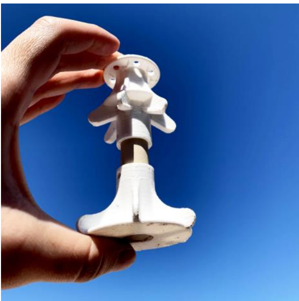
Figura 7.50 Propuesta de nodo 4. Impresión 3D, material PLA. Para domo en bambú. Fuente: Elaboración del autor
