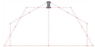
Figura 7.21 Izq. Modelado de nodo 2. Correspondencia de los ejes longitudinales de las barras con la geometría de las pletinas y centro de los agujeros del nodo Der. Sobreposición nodo en geometría de domo Fuente: Elaboración del autor
