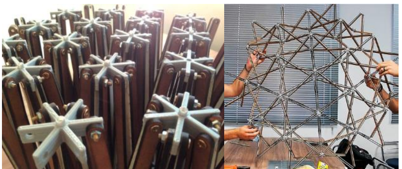
Figura 3.21 Detalle nodo (impresión 3d). Agrupación espacial a partir de tijeras rectas con articulación excéntrica. Red triangular. Despliegue con curvatura [87]. Fuente: Elaboración del autor. Workshop Pontificia Universidad Católica de Minas Gerais, Brasil. 2017
