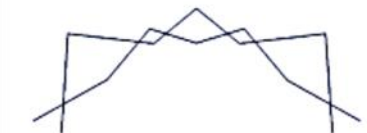
Figura 4.22 Método geométrico a partir de circunferencias tangenciales de diferente radio para configurar unidades de tijera polar con distintas dimensiones [19]
