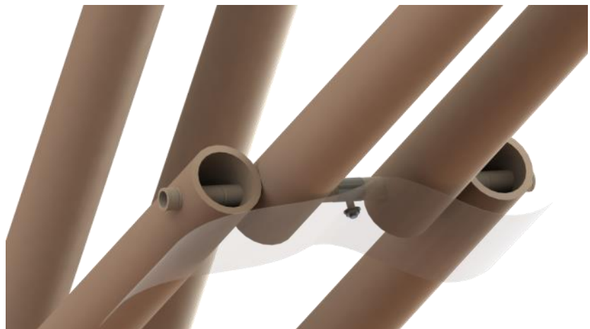
Figura 9.24 Detalle sujeción cubierta interior con abrazadera y perno. Fuente: Elaboración del autor
