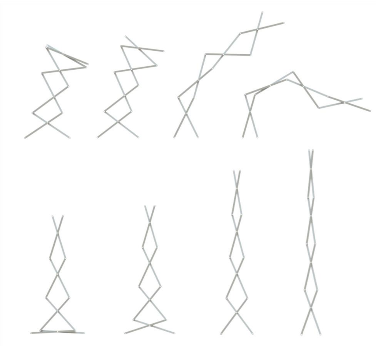
Figura 3.16 Proceso de despliegue de agrupación de tijeras rectas que no cumplen la condición de plegabilidad. Fuente: Elaboración del autor
