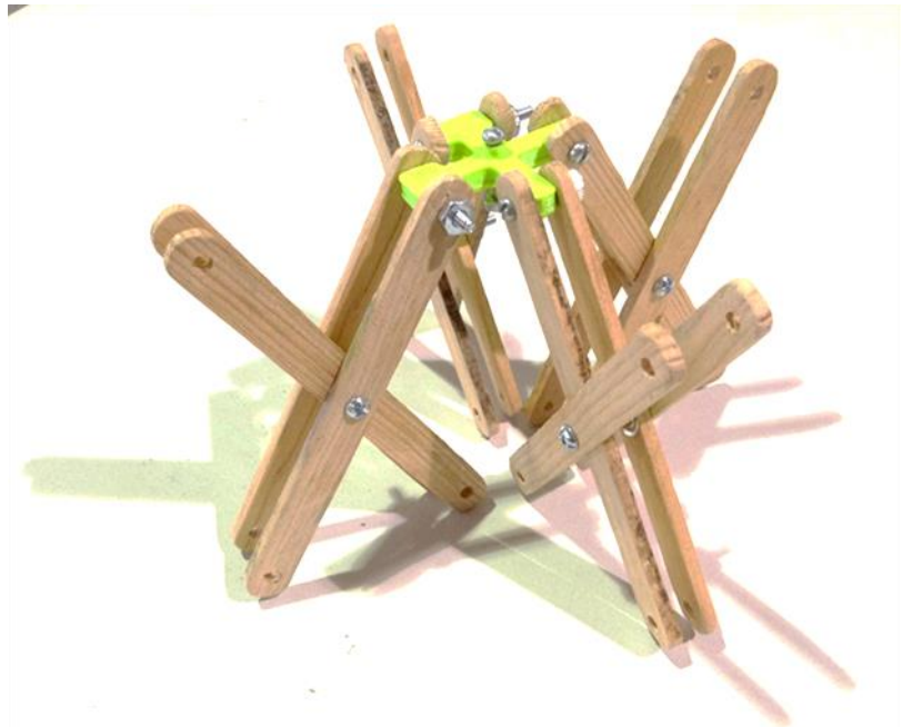
Figura 3.27 Ensamble de módulos de tijeras con doble barras (se incorpora doble barra para aumentar la sección de la barra, disminuir las deformaciones durante el despliegue y mejorar la durabilidad de la maqueta). Nodo en PLA, realizado con impresión 3d. Barras de madera, palos para helados. Conexiones entre elementos a través de tornillos y asegurados con tuercas. Fuente: Elaboración del autor. Workshop Tecnológico de Monterrey, 2015
