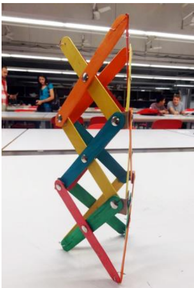
Figura 3.19 Torre desplegable. Agrupación espacial de tijeras rectas con articulación central. Red triangular. Despliegue lineal. Fuente: Resultados maquetas taller SMiA. Optativa Construcción ligera ETSAV, 2018 https://smia-experimental.com/ Recuperado [10/01/2019]
