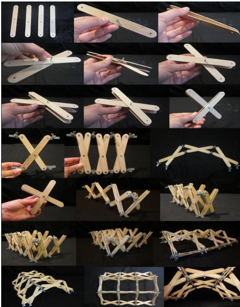
Figura 3.44 Exploración de diferentes maquetas, aumentando la excentricidad en las barras. Entre mayor excentricidad, el diámetro interno del arco disminuye. Modelos y fotografías realizados por Annamaria Patiño Lakatos. Fuente: Elaboración del autor
