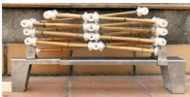
Figura 10.71 Ensamble barra de bambú con abrazaderas y configuración de los semiarcos desplegables.
