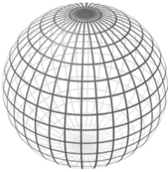
Figura 3.63 Esquema del trazado de geodésicas en una esfera, meridianos y paralelos. Fuente: Elaboración del autor
