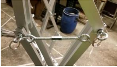
Figura 10.35 Sistema de bloqueo Stand desplegable. Fuente: Elaboración del autor
