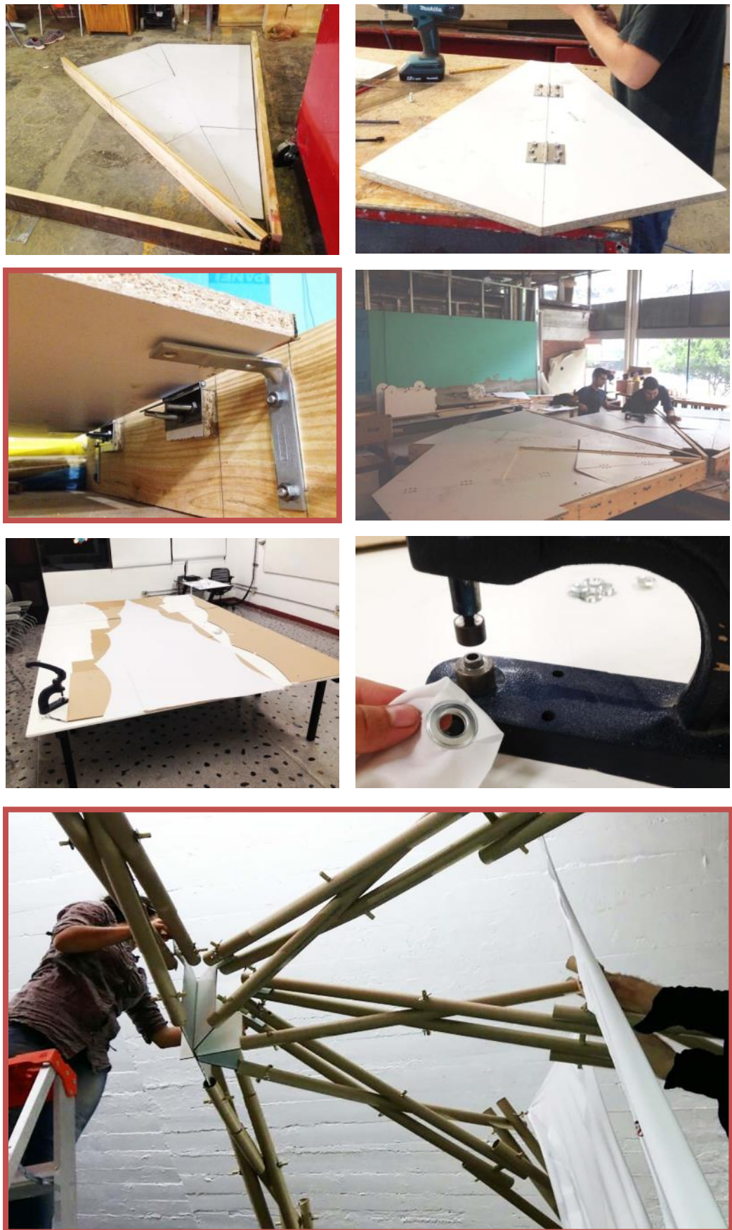
Figura 10.15 b Seguimiento fotográfico, fabricación y ensamble escenario desplegable. Fuente: Elaboración del autor
