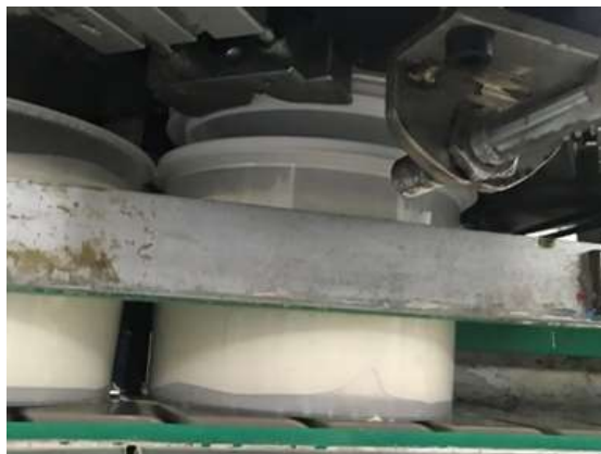
Figura 9: Colocación tapas 500 [Elaboración propia]
