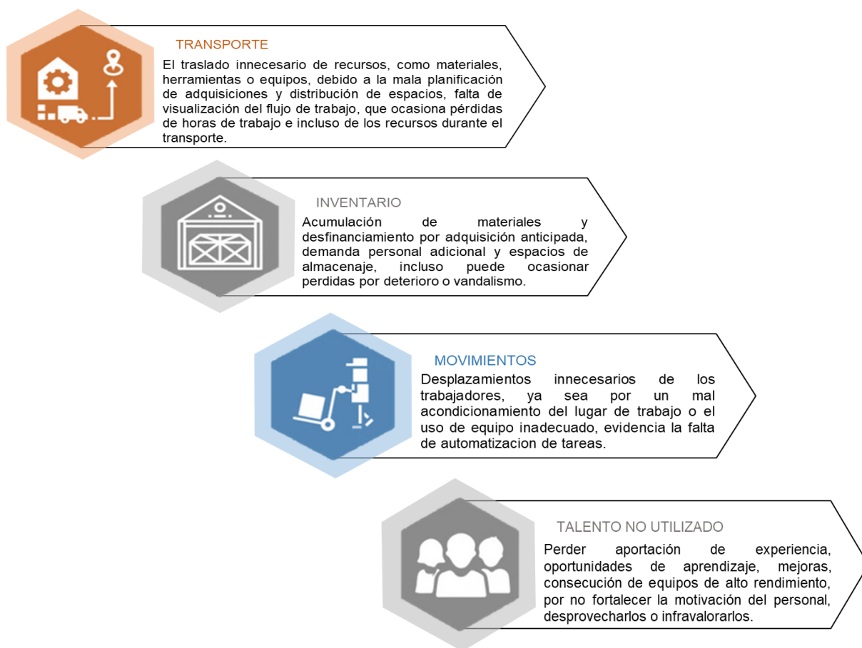
Gráfico 3.8 Desperdicios en la construcción Fuente: Latorre, 2015 y Pons Achell, J., 2014. Elaboración: propia
