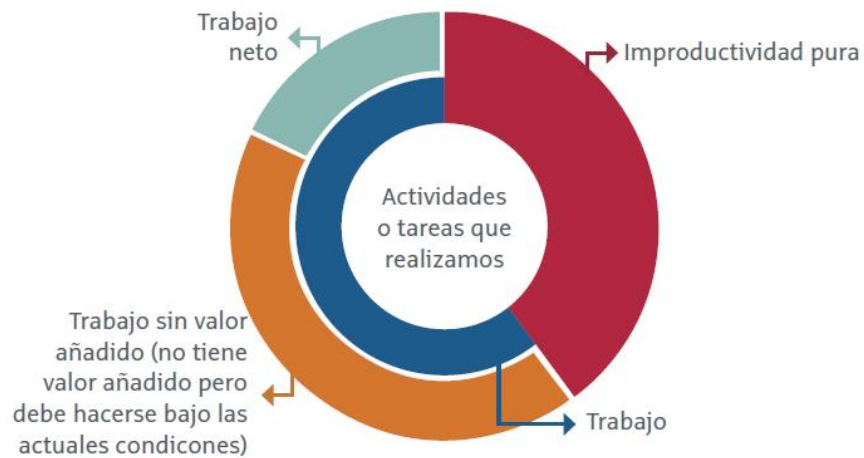
Gráfico 3.7 Círculo de la inproductividad de una empresa Fuente: Introducción a Lean Construction, Pons Achell, J., 2014 (adaptado de Ohno, 1988)
