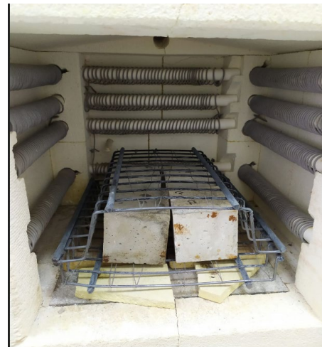
Figura 1. Probetas y su protección en el interior del horno.
