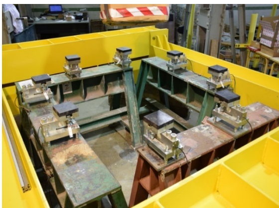
Fig. 5. Sistema de apoyos sobre células de carga.
