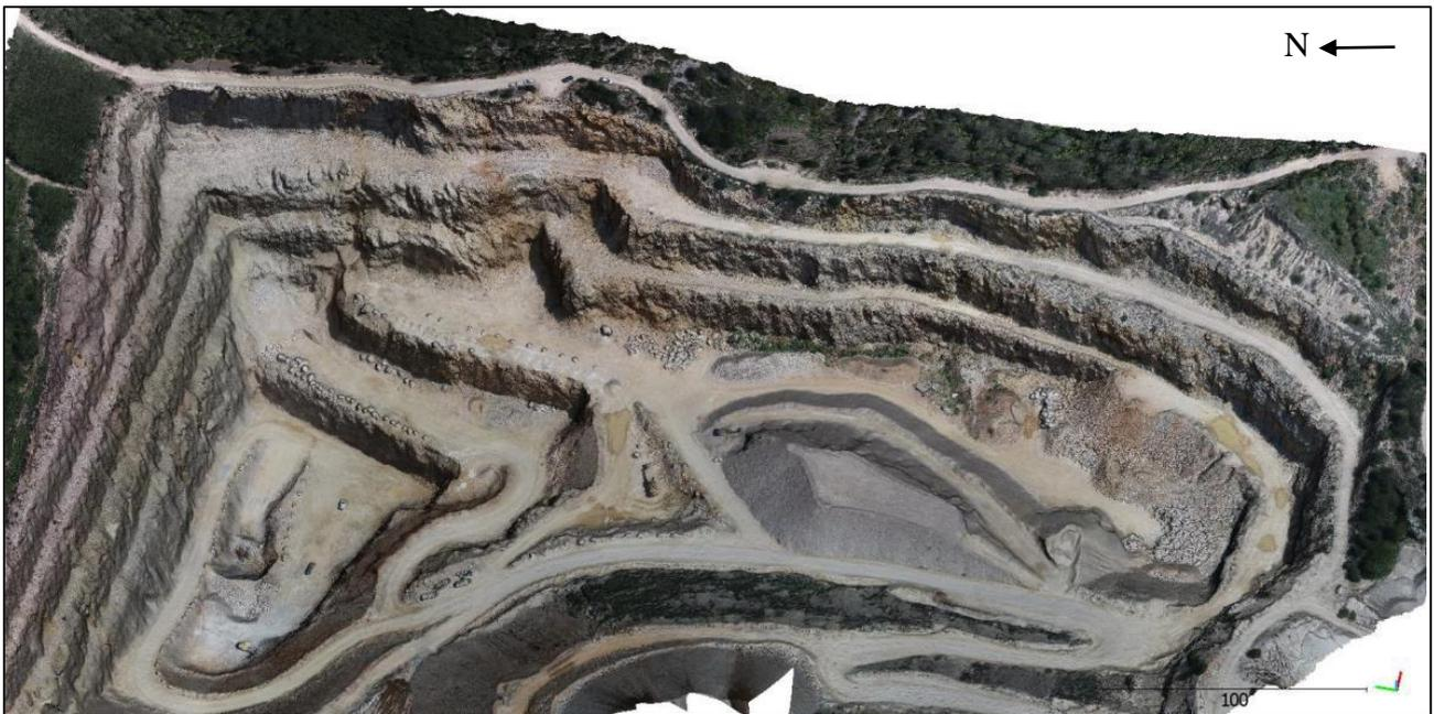
Figura 7: Modelo 3D de la cantera obtenido mediante el vuelo de dron y la reconstrucción fotogramétrica.
