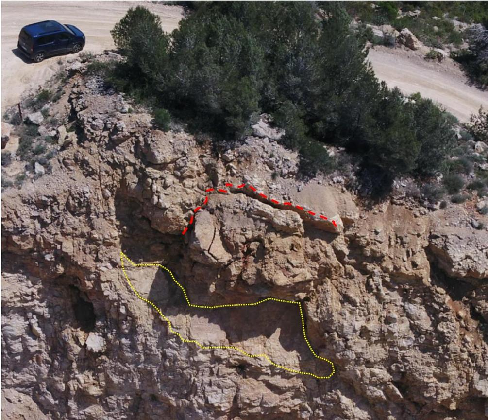
Figura 13: Fotografía de dron de la cicatriz de una rotura planar y de un volumen potencialmente inestable.
