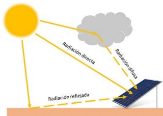
Figura 3 – Radiacions sobre superfície inclinada. [I3]
