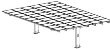
Figura 25 – Estructura de suport tipus marquesina. [112]
