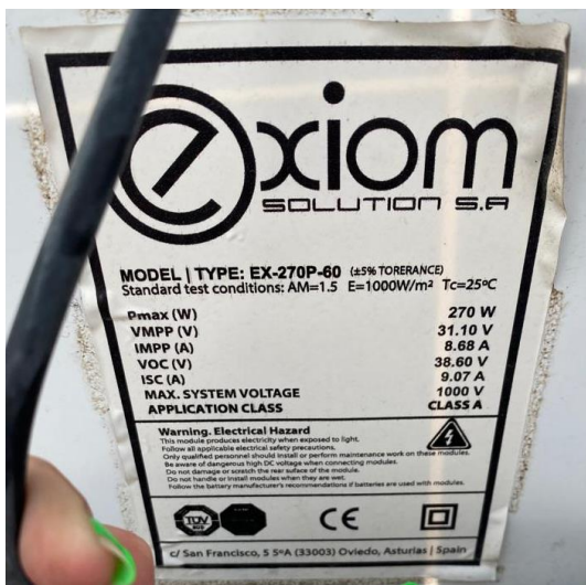
Figura 51 – Característiques tècniques del captador instal·lat a planta.
