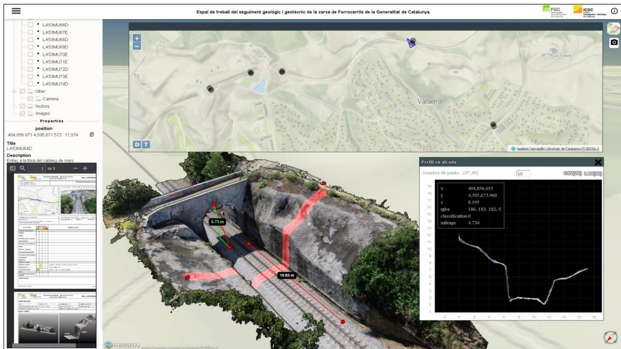
Figura 7. Visor web 3D del catálogo de muros de contención de la línea Llobregat-Anoia de FGC, donde se ejemplifican algunas de las herramientas de medición presentes en el visor y complementariamente se puede consultar el estado del activo.
