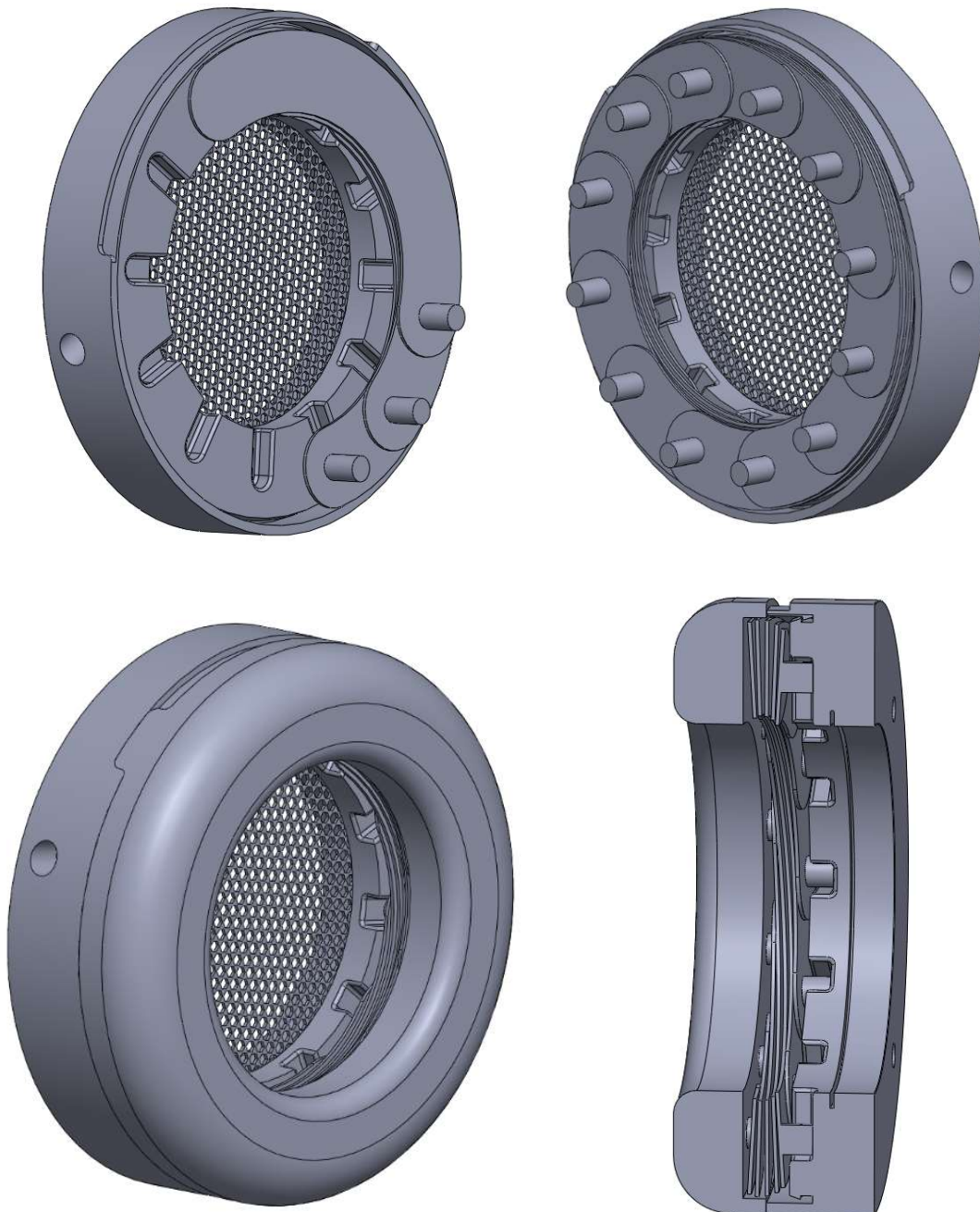
Figura 19. Superposició de les fulles, model del conjunt del diafragma d'iris obert i model seccionat. Font: Elaboració pròpia.
