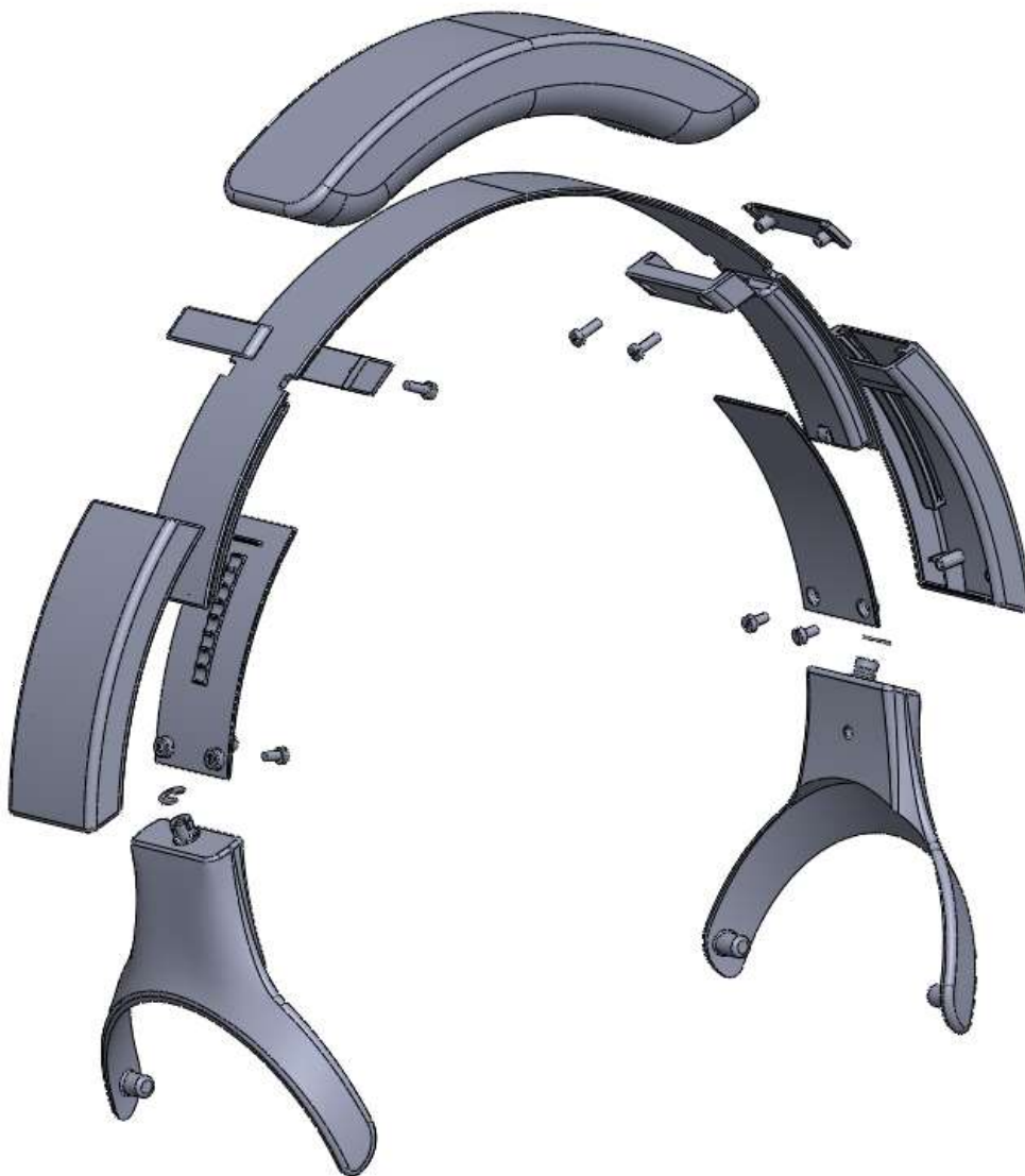
Figura 25. Modelat dels components de la diadema dels auriculars. Font: Elaboració pròpia.
