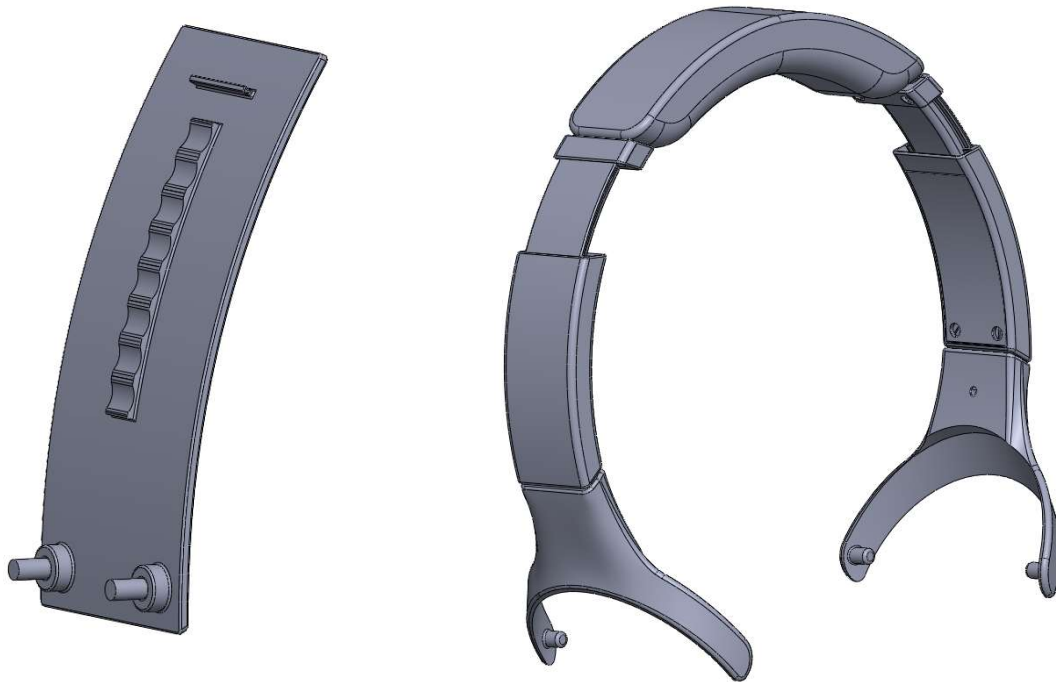
Figura 29. Part lliscant interior i model complet de la diadema extensa. Font: Elaboració pròpia.
