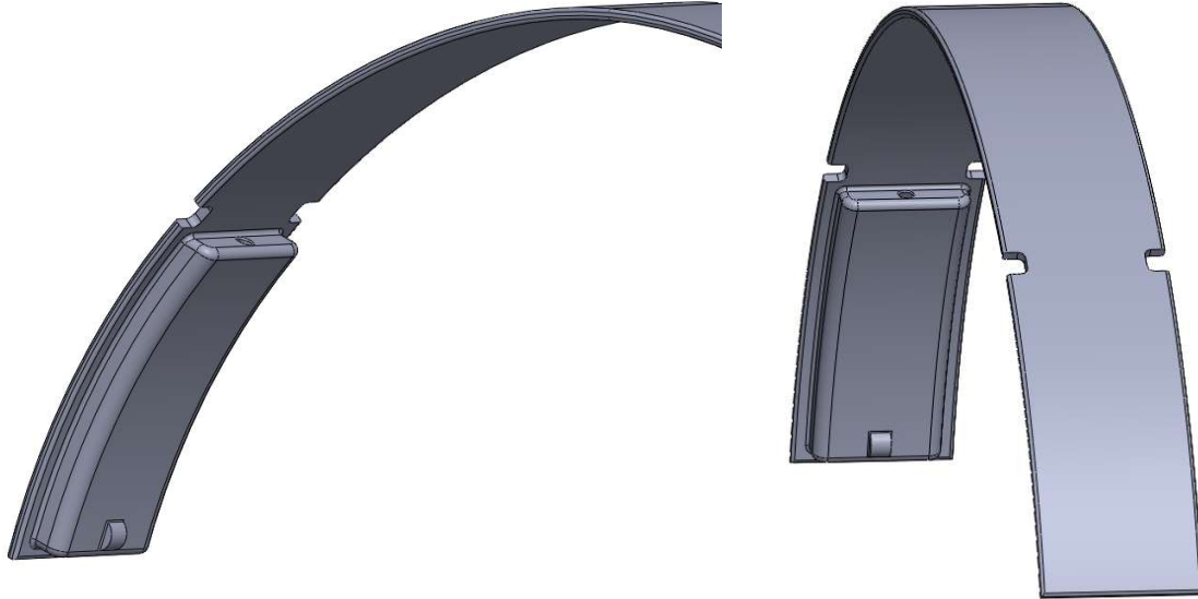
Figura 27. Diadema central, extrusió i relleu a l'extrem d'aquesta extrusió. Font: Elaboració pròpia.
