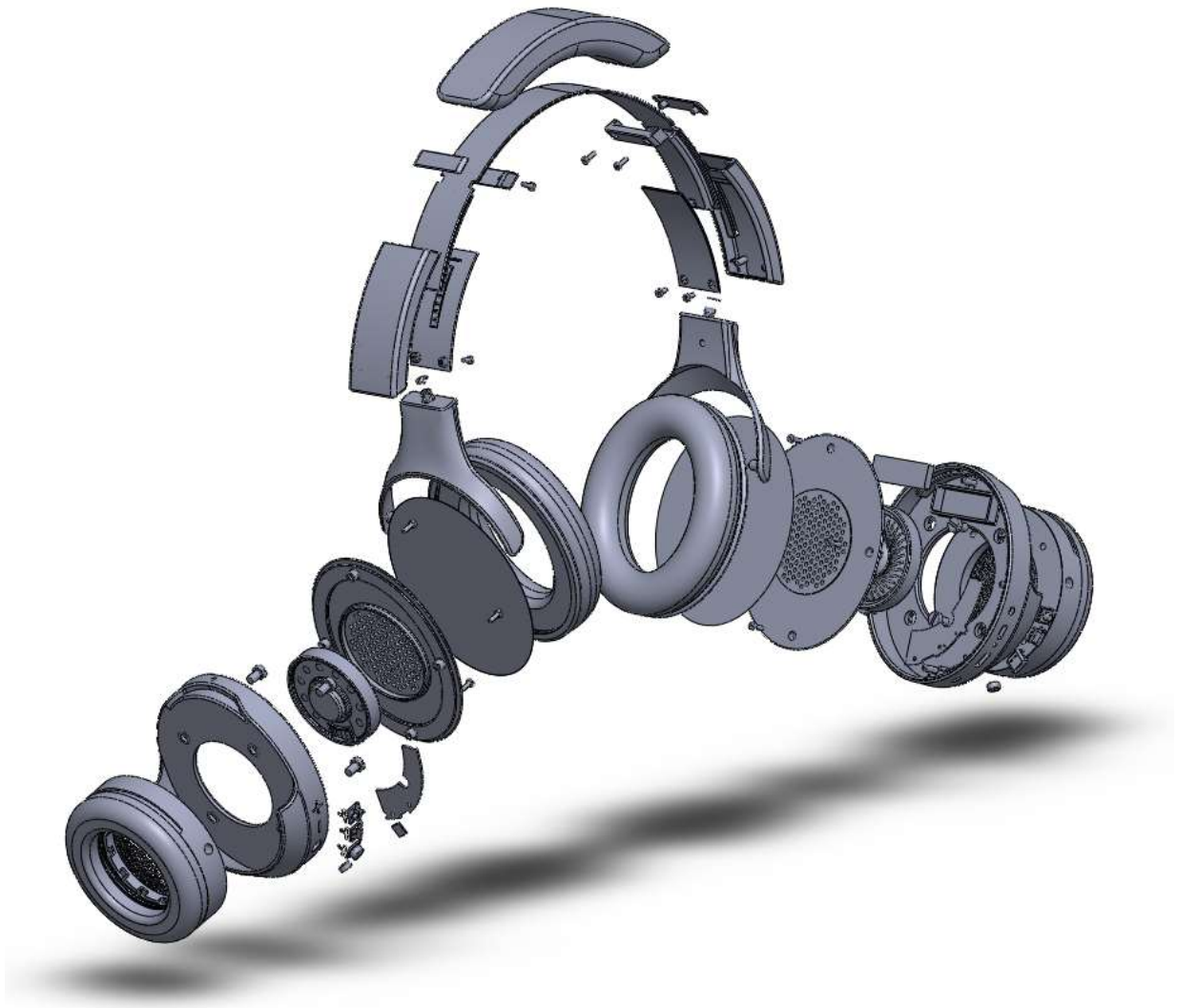
Figura 36. Model final de la proposta explosionat. Font: Elaboració pròpia.
