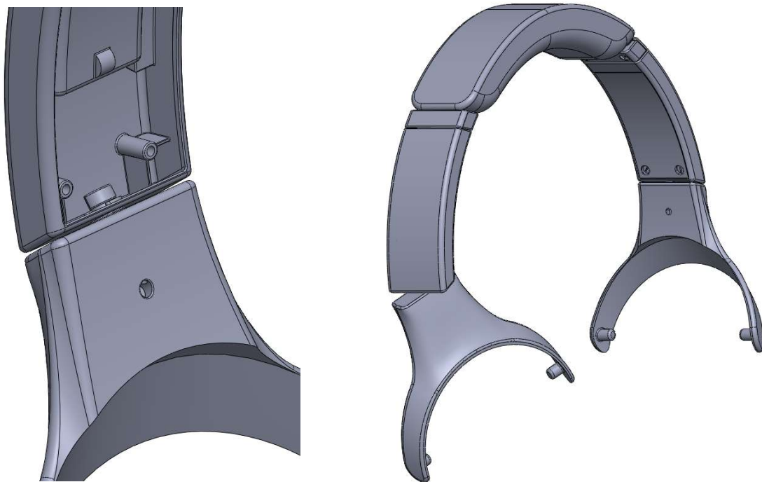
Figura 26. Unió de la forqueta amb la part lliscant exterior i rotació de la forqueta. Font: Elaboració pròpia.
