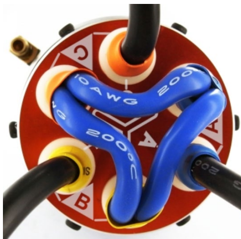
Ilustración 46 Conexión en estrella
