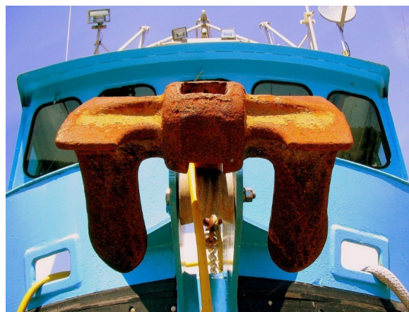
Ilustración 7 Corrosión en el ancla de un buque
