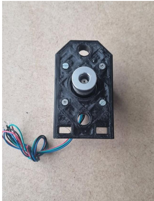
Il·lustració 12: Suport de motor de l'eix Y amb motor i acoplador
