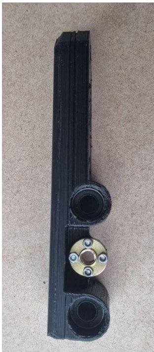
Il·lustració 10: Suport del motor de l'eix X amb casquets i rosca de llautó
