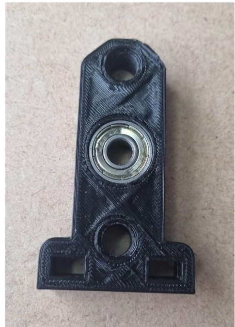
Il·lustració 11: Suport eix Y amb rodament
