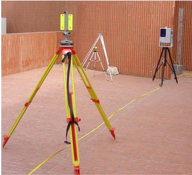
Figura 2: Prueba de la influencia de distancia sobre señal de puntería.
