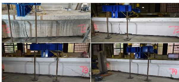
**Figura 17. Fisuración en rotura en los 4 ensayos.**
