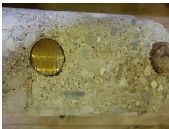
Figura 9. Estado de las armaduras en el interior del hormigón.
