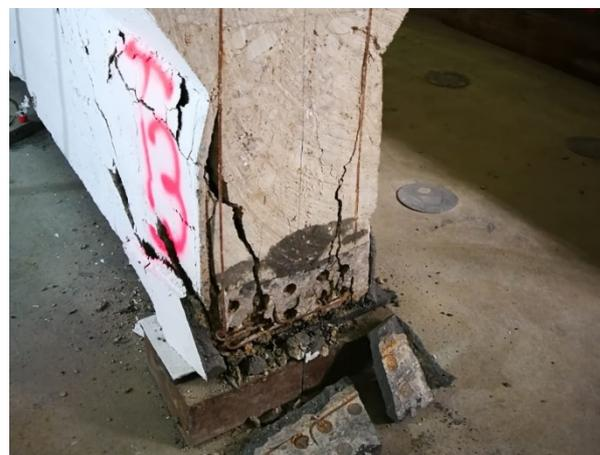
**Figura 19. Deslizamiento de la armadura longitudinal.**
