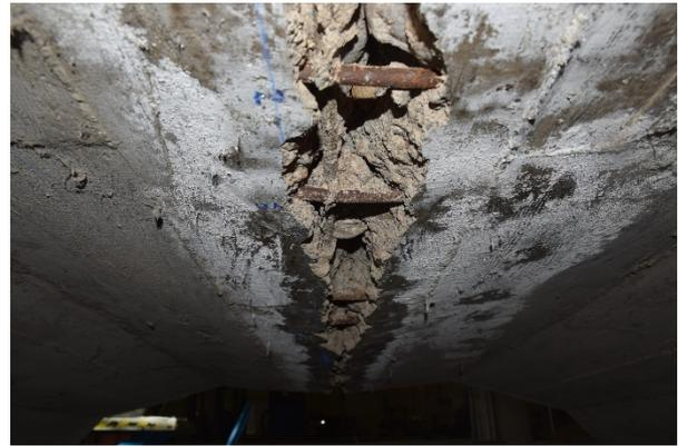
Figura 11. Vista inferior de la pieza 1 al final del ensayo.
