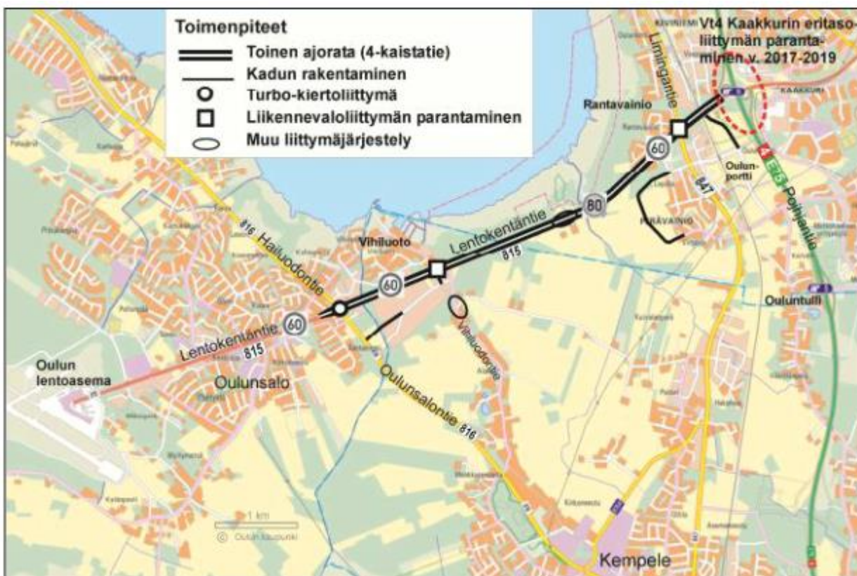
Kuva 19. Vaihtoehto VE1; nelikaistainen Lentokentäntie ja tasoliittymät. Lähde: Mt 815 Lentokentätien kehittämisselvitys välillä Hailuodontie (Mt 816) – Pohjantie (Vt 4) (ELY-keskuksen raportteja 28/2017)
