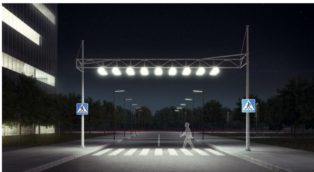
Рисунок 2.2 – Вид освещения пешеходных переходов светодиодными светильниками
