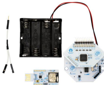
Figura 25. Placa OpenBCI CytonDaisy. Fuente: (OpenBCI, 2022).
