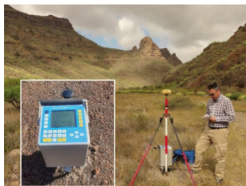
Figura 2. Tomando datos de gravedad sobre la superficie terrestre con un gravímetro Scintrex CG5.
