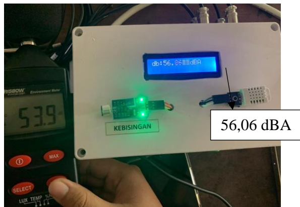
Gambar 4.8 Pengujian Sensor Kebisingan Saat Keadaan Hening
