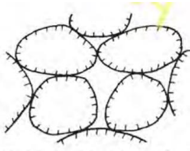
Figura 8. Empaque de partículas grandes con tamaños de grano pequeños removidos (pobrememente gradada)
