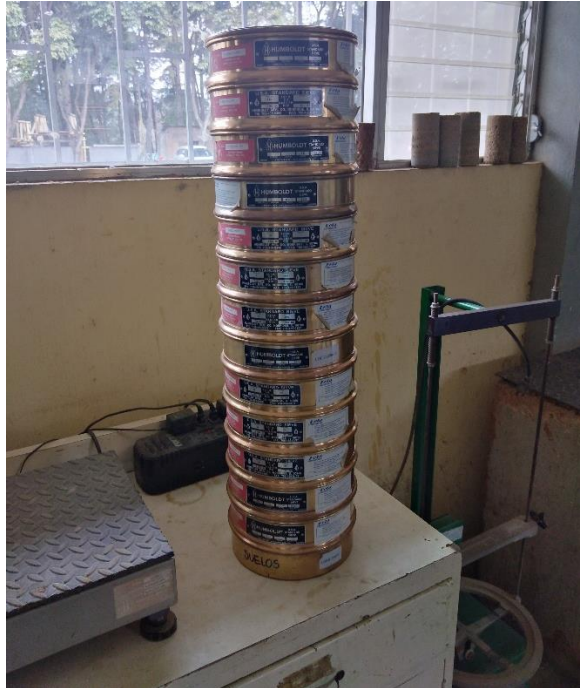
Figura 26. Equipo utilizado para el ensayo de granulometría
