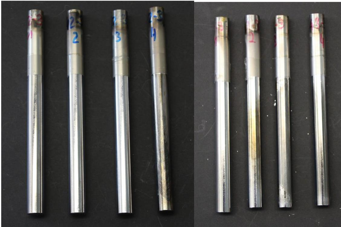
Abbildung VI.5: Links: Beschichtete Stahlstangen aus dem Äpfelsäure Elektrolyten. Rechts: Beschichtete Stahlstangen aus dem Glycolsäure Elektrolyten.
