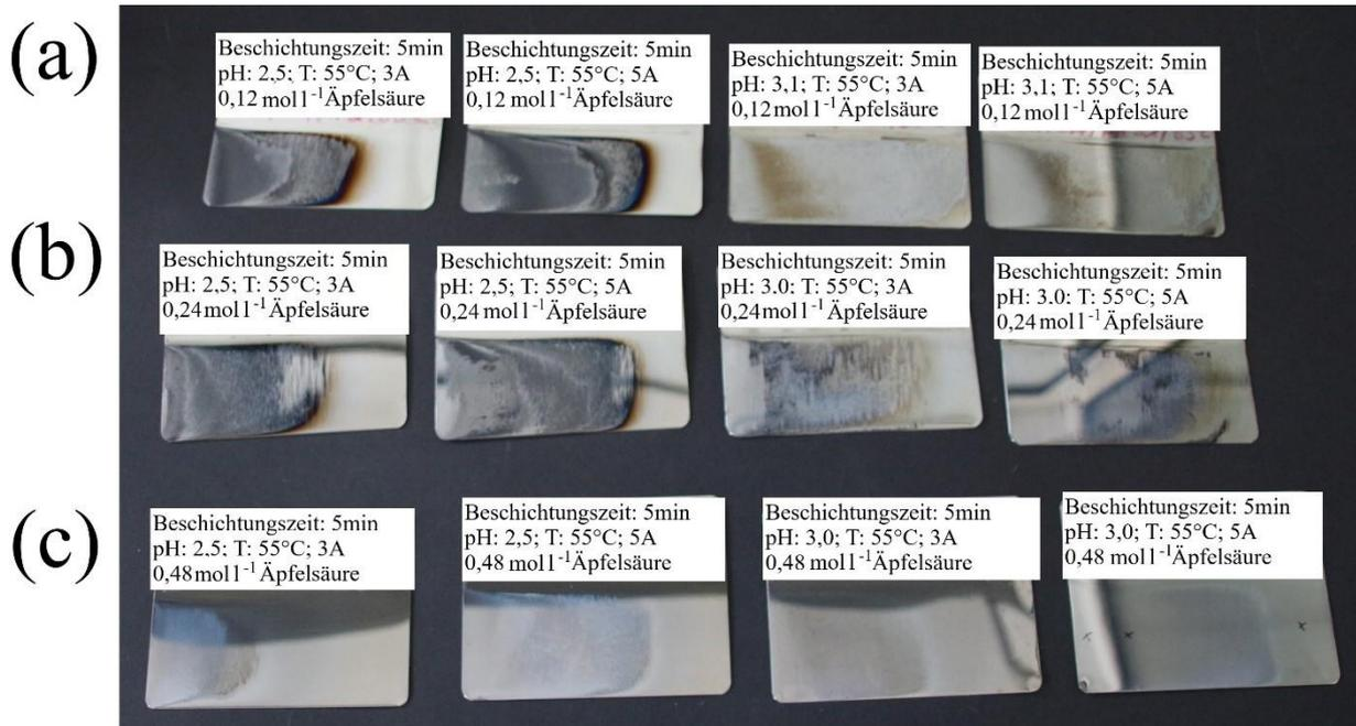
Abbildung VI.3: Mit dem Äpfelsäure-haltigen Elektrolyten beschichteten Hullzellenbleche. Unterschiedliche Konzentrationen an Carbonsäure (a) 0,12 mol l<sup>-1</sup>; (b) 0,24 mol l<sup>-1</sup> und (c) 0,48 mol l<sup>-1</sup> wurden bei pH Wert 2 und 3 und bei unterschiedlichen Zellstrom (3 und 5A) hinsichtlich ihres Einflusses auf die Chrom-Abscheidung untersucht.
