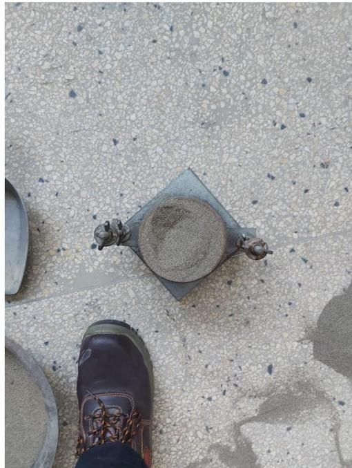
FIGURA a8. Molde con muestra
