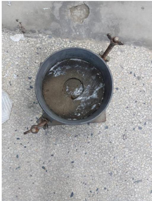
FIGURA a6. Ensayo de Proctor
