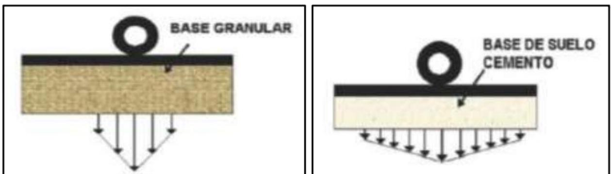
**Figura 8.** Distribución de esfuerzos en una estabilización mecánica y química
