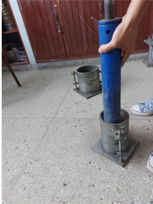
FIGURA a9. Ensayo de Proctor
