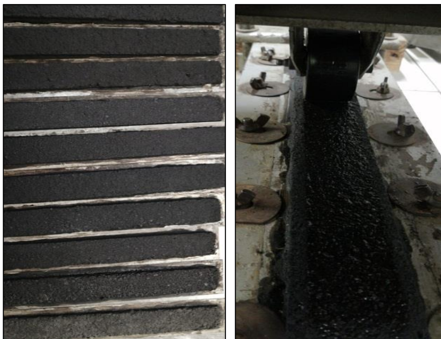
Figura 24. Ensayo rueda cargada y adhesión de arena LWT
