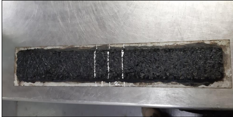
Figura 25: Muestra desplazamiento lateral
