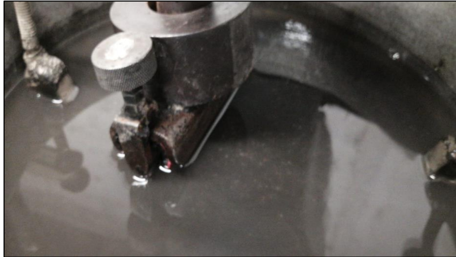
Figura 23. Ensayo abrasión en húmedo WTAT
