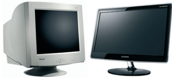
Figuur 3. Voorbeeld van een CRT-monitor (links) en een lcd-monitor (rechts). Bron: Astute Graphics Ltd.
