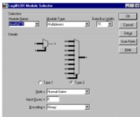
Figura 9. Creación de un multiplexor 8 a 1 de 16 bits
