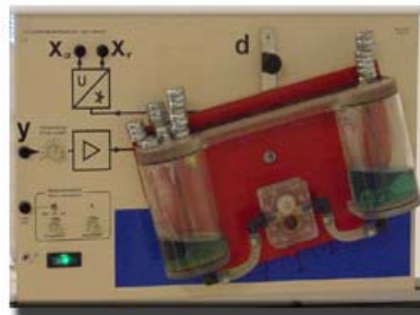
Figura n° 4: Las maquetas de nivel, temperatura y estabilizador de barcos.
