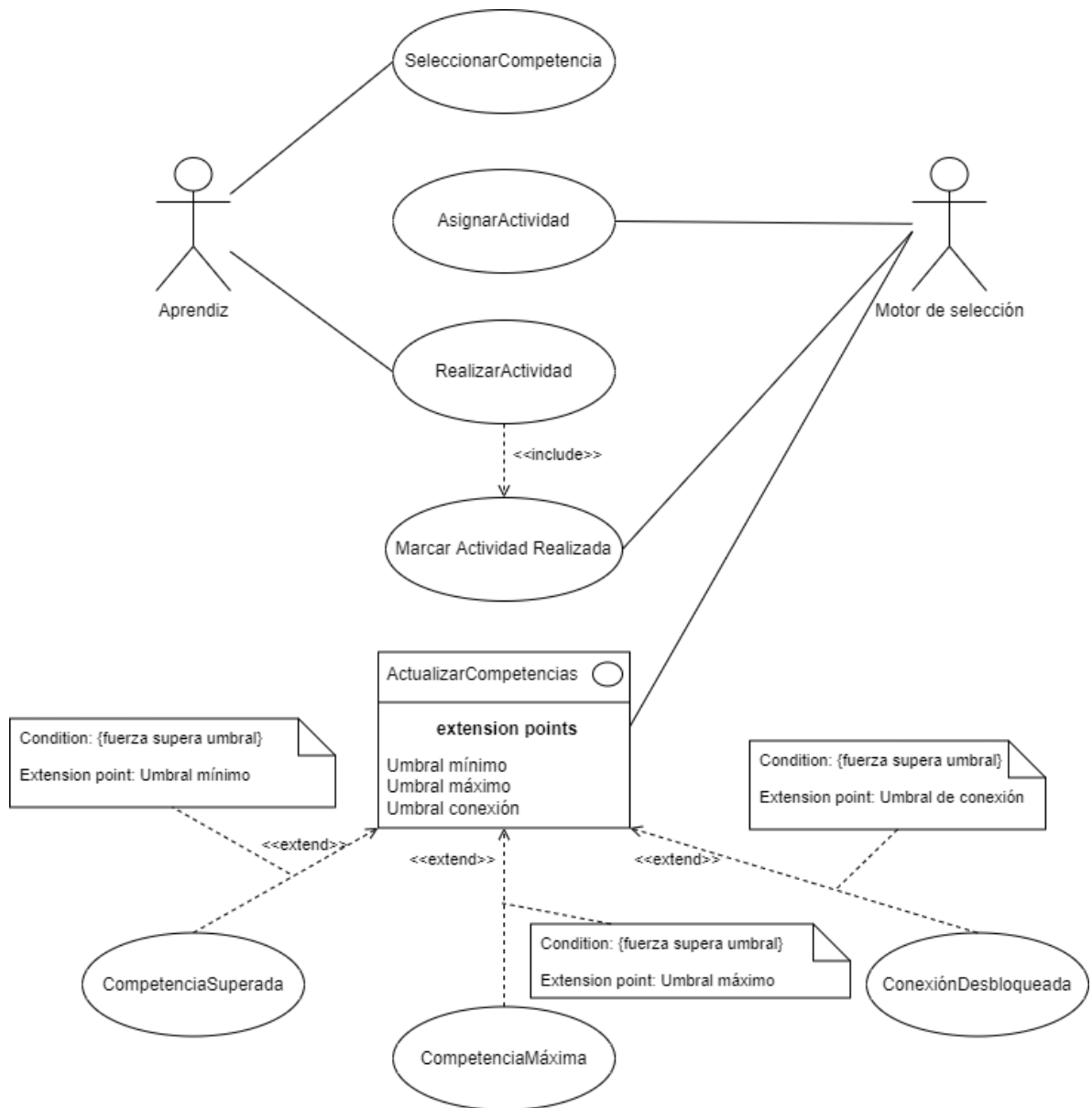
Figura 13. Diagrama de casos de uso que representa la selección de una competencia por parte de un aprendiz, y en consecuencia la realización de una actividad.
