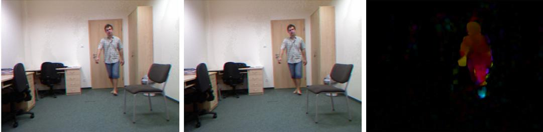
Figura 6.4: Ejemplo del flujo óptico denso de 2 imágenes del UR Fall Detection Dataset.
