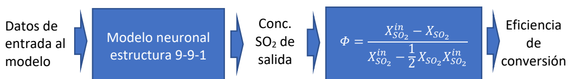
Figura 46 Sensor virtual obtenido para la predicción de la eficiencia de conversión. Fuente: Elaboración propia.
