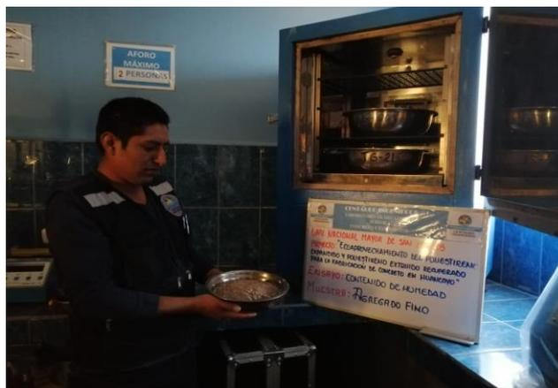
FIGURA 12: CONTENIDO DE HUMEDAD DEL AGREGADO FINO
