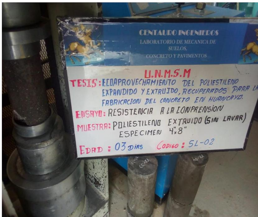
FIGURA 39: ESPÉCIMEN DE 4" X 8" DE 7 DÍAS, SUSTITUCIÓN DEL 40% AGREGADO FINO Y 30% AGREGADO GRUESO - ASTM C39/C39M-12 – XPS SIN LAVAR.
