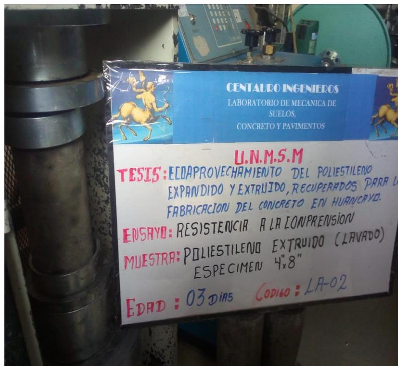
FIGURA 35: ESPÉCIMEN DE 4" x 8" DE 3 DÍAS, CON SUSTITUCIÓN DEL 70% AGREGADO FINO Y 60% AGREGADO GRUESO - ASTM C39/C39M-12 – XPS.
