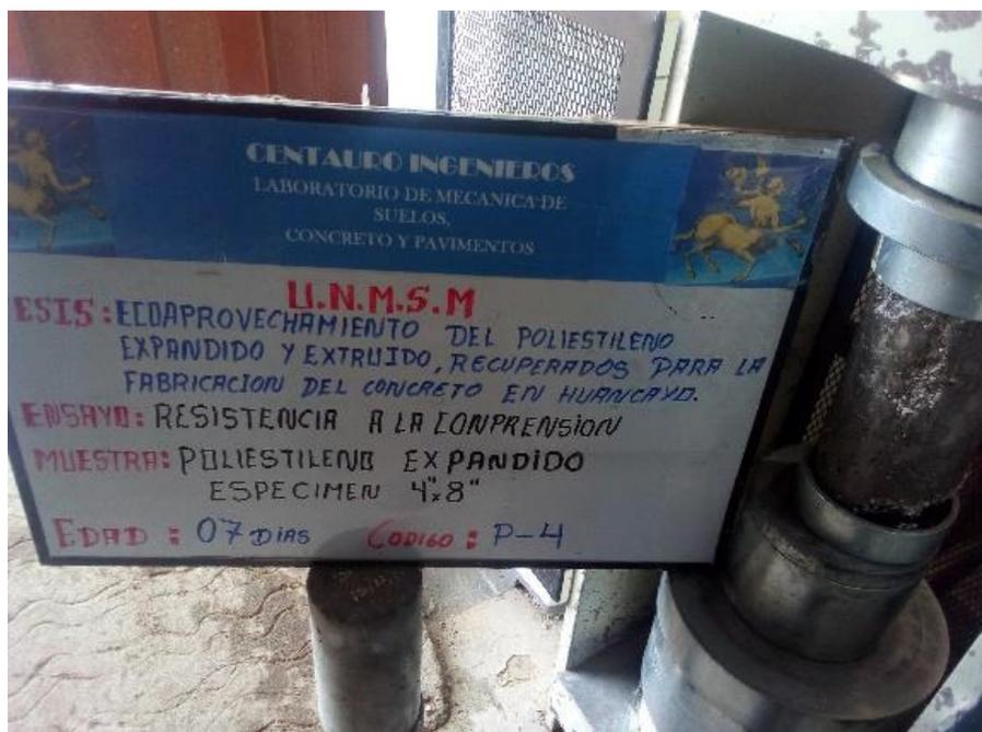
FIGURA 21: ESPÉCIMEN DE 4" X 8" DE 7 DÍAS PARA ENSAYO MECÁNICO DE RESISTENCIA - ASTM C39/C39M-12 – EPS
