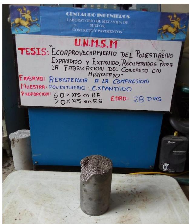
FIGURA 30: ESPÉCIMEN ENSAYADO DE 4" X 8" DE 28 DÍAS, CON SUSTITUCIÓN DEL 60% AGREGADO FINO Y 70% AGREGADO GRUESO - EPS - ASTM C39/C39M-12
