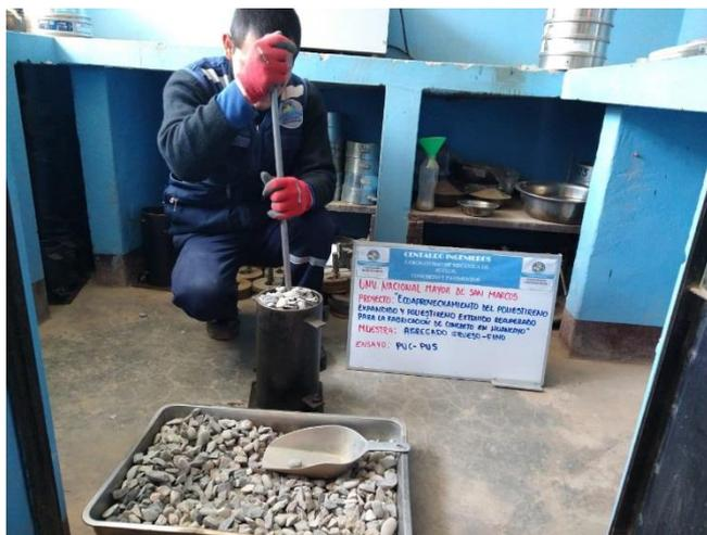
FIGURA 11: PESO UNITARIO COMPACTADO DEL AGREGADO GRUESO - A.S.T.M. C29/C29M - 17 A
