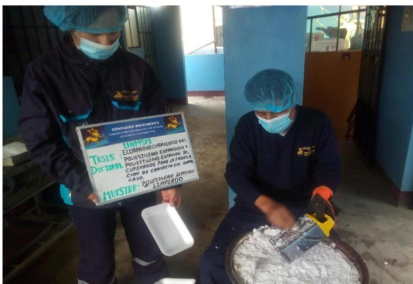
FIGURA 5: DESMENUZADO DEL POLIESTIRENO EXTRUIDO CON UN RAYADOR DOMESTICO
