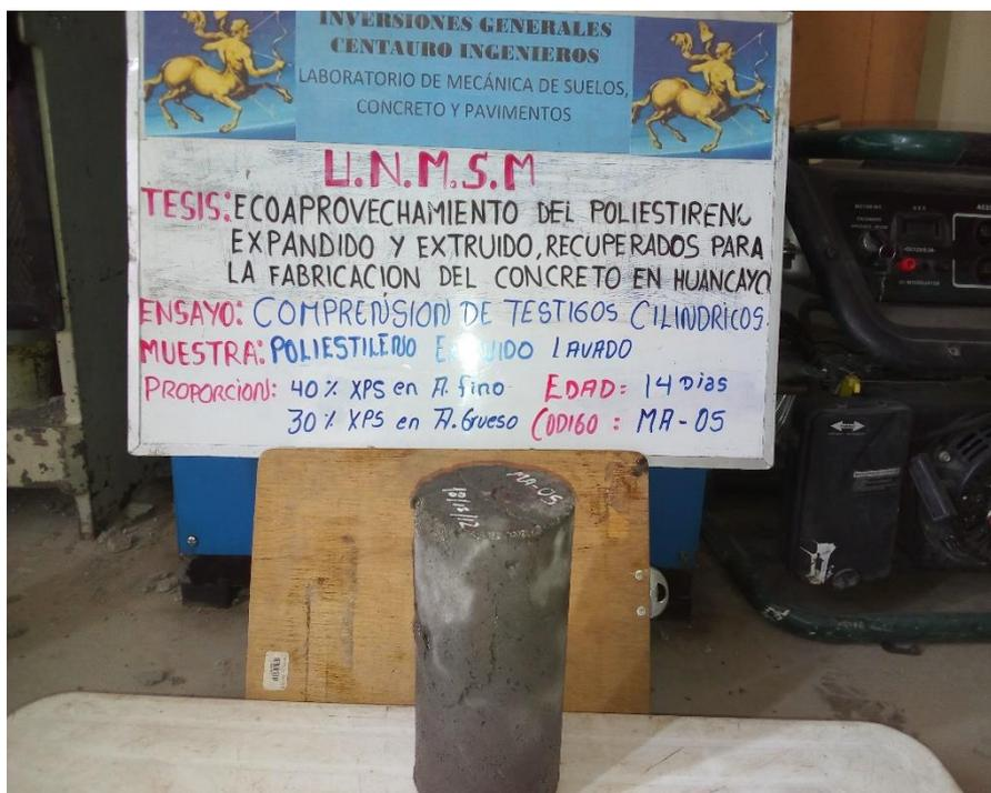
FIGURA 33: ESPÉCIMEN DE 4" X 8" DE 14 DÍAS, CON SUSTITUCIÓN DEL 40% AGREGADO FINO Y 30% AGREGADO GRUESO - ASTM C39/C39M-12 – XPS LAVADO.
