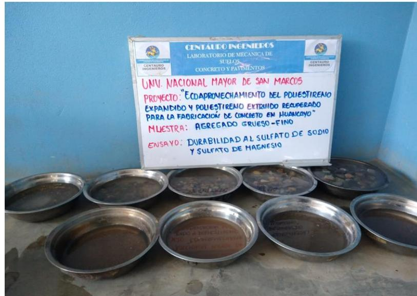
FIGURA 17: DURABILIDAD AL SULFATO DE MAGNESIO DEL AGREGADO GRUESO Y FINO - MTC E 209-2016
