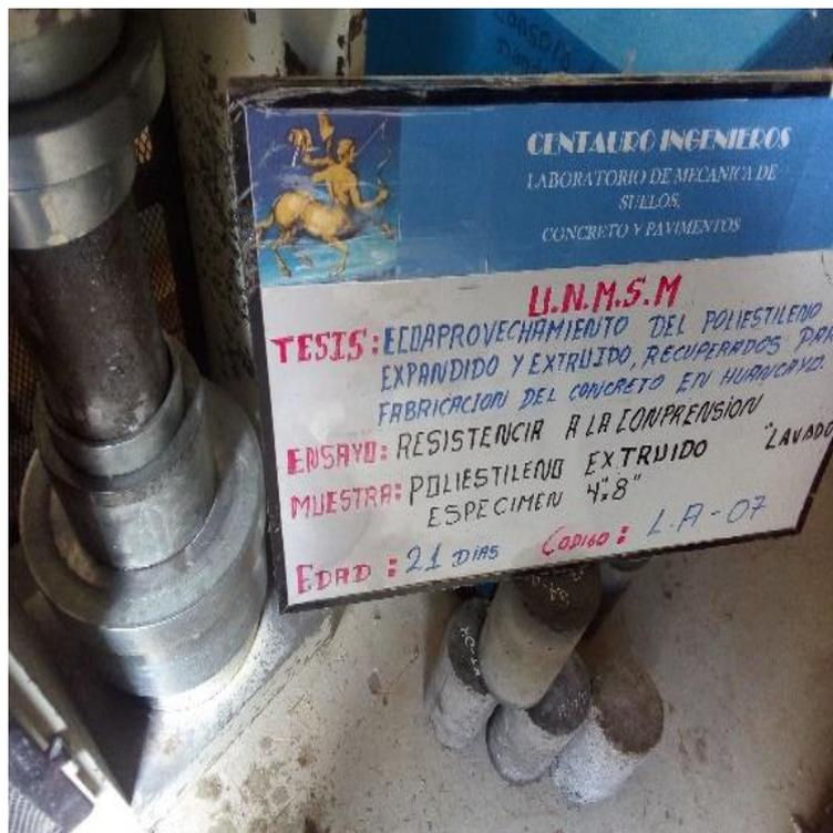
FIGURA 36: ESPÉCIMEN DE 4" x 8" DE 21 DÍAS, CON SUSTITUCIÓN DEL 70% AGREGADO FINO Y 60% AGREGADO GRUESO - ASTM C39/C39M-12 – XPS LAVADO.
