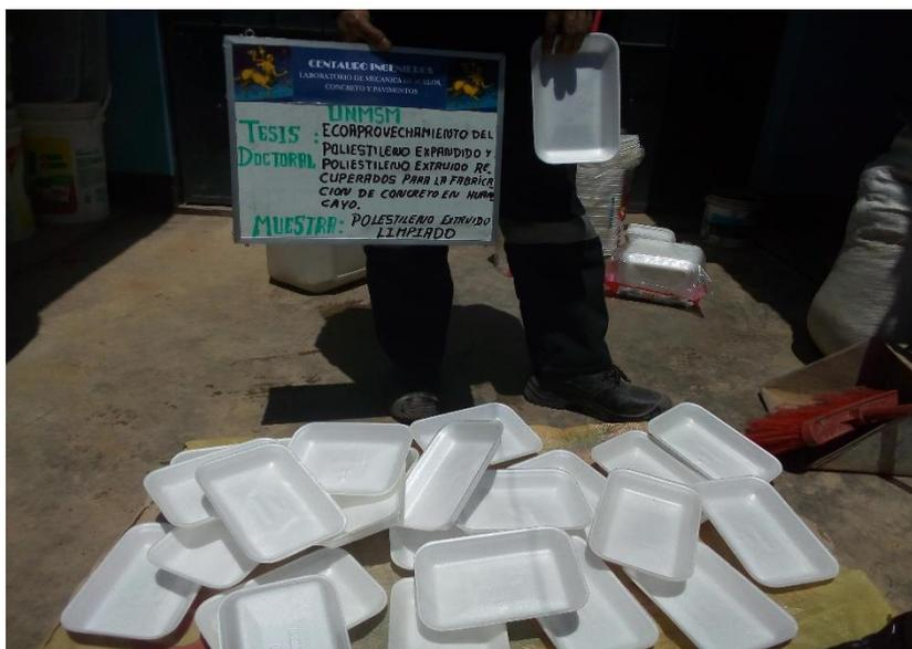
FIGURA 4: POLIESTIRENO EXTRUIDO LAVADO Y SECADO CON UN PAÑO ABSORBENTE
