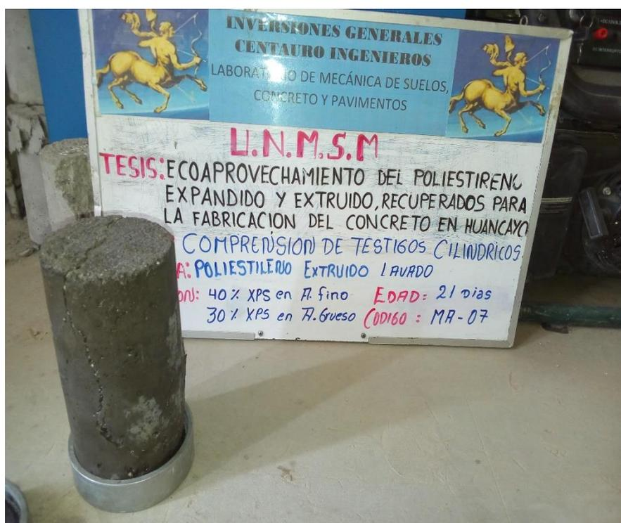
FIGURA 34: ESPÉCIMEN DE 4" X 8" DE 21 DÍAS, CON SUSTITUCIÓN DEL 40% AGREGADO FINO Y 30% AGREGADO GRUESO - ASTM C39/C39M-12 – XPS LAVADO.
