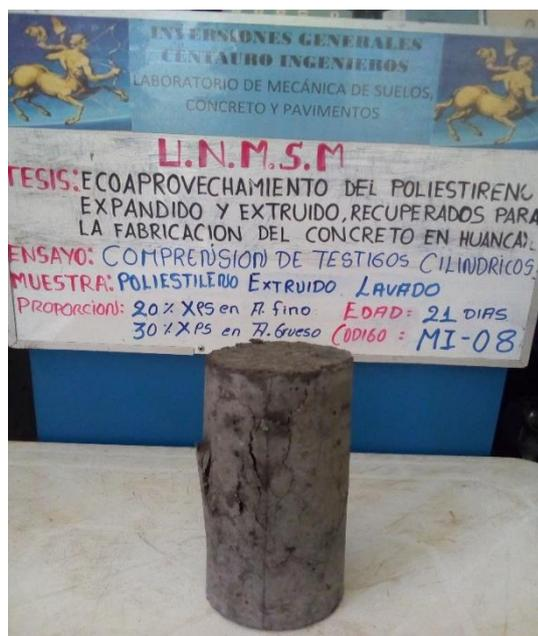
FIGURA 32: ESPÉCIMEN ENSAYADO DE 4" X 8" DE 21 DÍAS, CON SUSTITUCIÓN DEL 20% AGREGADO FINO Y 30% AGREGADO GRUESO - XPS LAVADO - ASTM C39/C39M-12
