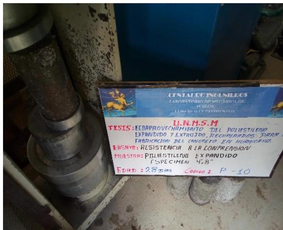
FIGURA 24: ESPÉCIMEN DE 4" x 8" DE 28 DÍAS PARA ENSAYO MECÁNICO DE RESISTENCIA - ASTM C39/C39M-12 – EPS
