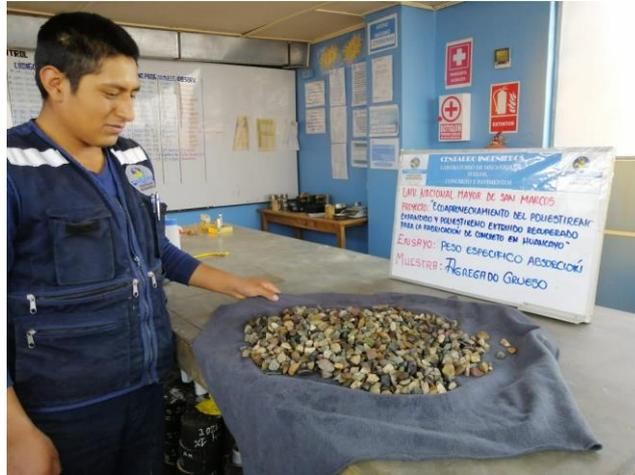
FIGURA 9: PESO ESPECÍFICO DEL AGREGADO GRUESO
