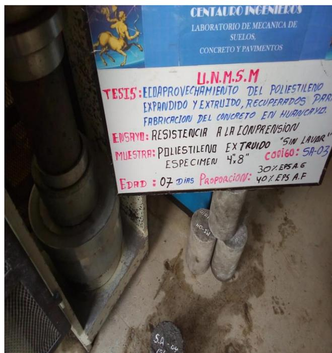
FIGURA 38: ESPÉCIMEN DE 4" x 8" DE 7 DÍAS, SUSTITUCIÓN DEL 40% AGREGADO FINO Y 30% AGREGADO GRUESO - ASTM C39/C39M-12 – XPS SIN LAVAR.
