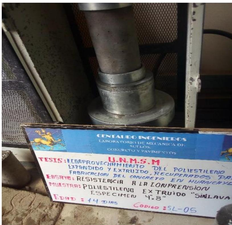
FIGURA 40: ESPÉCIMEN DE 4" X 8" DE 7 DÍAS, SUSTITUCIÓN DEL 40% AGREGADO FINO Y 30% AGREGADO GRUESO - ASTM C39/C39M-12 – XPS SIN LAVAR
