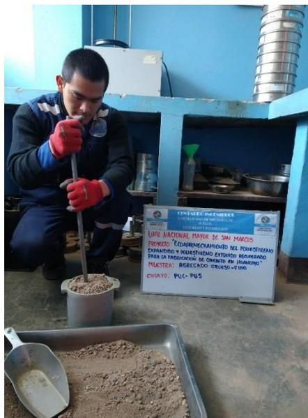
FIGURA 10: PESO UNITARIO COMPACTADO DEL AGREGADO FINO
