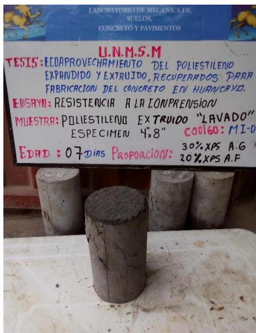
FIGURA 31: ESPÉCIMEN ENSAYADO DE 4" X 8" DE 7 DÍAS, CON SUSTITUCIÓN DEL 30% AGREGADO FINO Y 20% AGREGADO GRUESO - XPS LAVADO - ASTM C39/C39M-12
