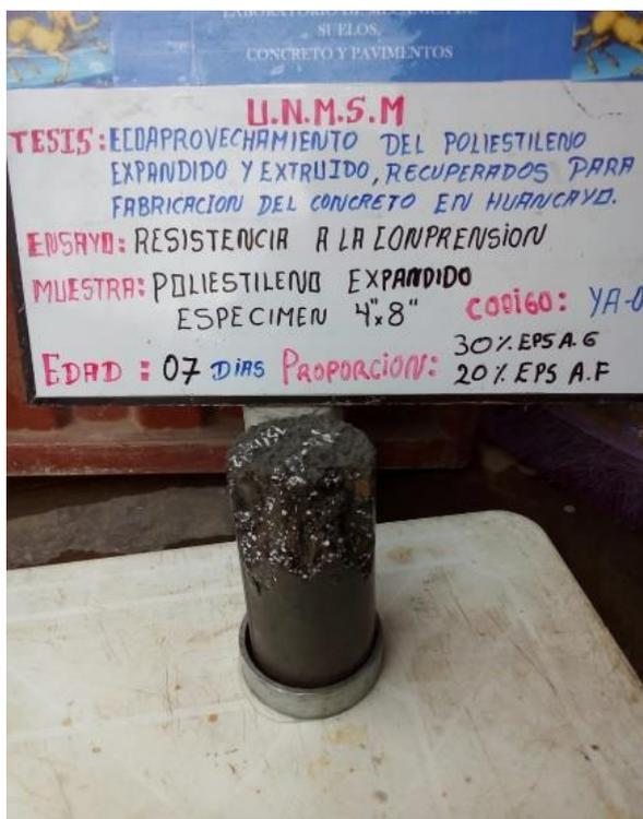
FIGURA 27: ESPÉCIMEN ENSAYADO DE 4" X 8" DE 7 DÍAS, CON SUSTITUCIÓN DEL 20% AGREGADO FINO Y 30% AGREGADO GRUESO – EPS. ASTM C39/C39M-12
