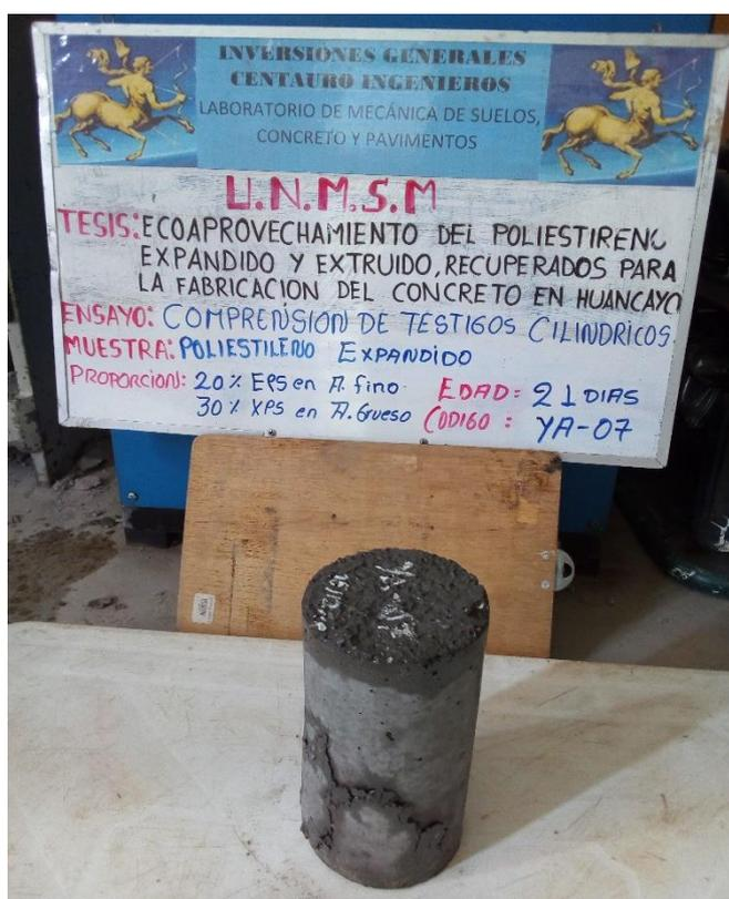
FIGURA 28: ESPÉCIMEN DE 4" X 8" DE 21 DÍAS, CON SUSTITUCIÓN DEL 20% AGREGADO FINO Y 30% AGREGADO GRUESO – EPS - ASTM C39/C39M-12
