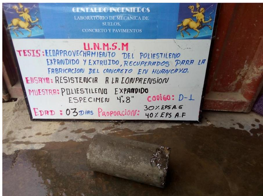
FIGURA 29: ESPÉCIMEN ENSAYADO DE 4" X 8" DE 3 DÍAS, CON SUSTITUCIÓN DEL 40% AGREGADO FINO Y 30% AGREGADO GRUESO - EPS - ASTM C39/C39M-12
