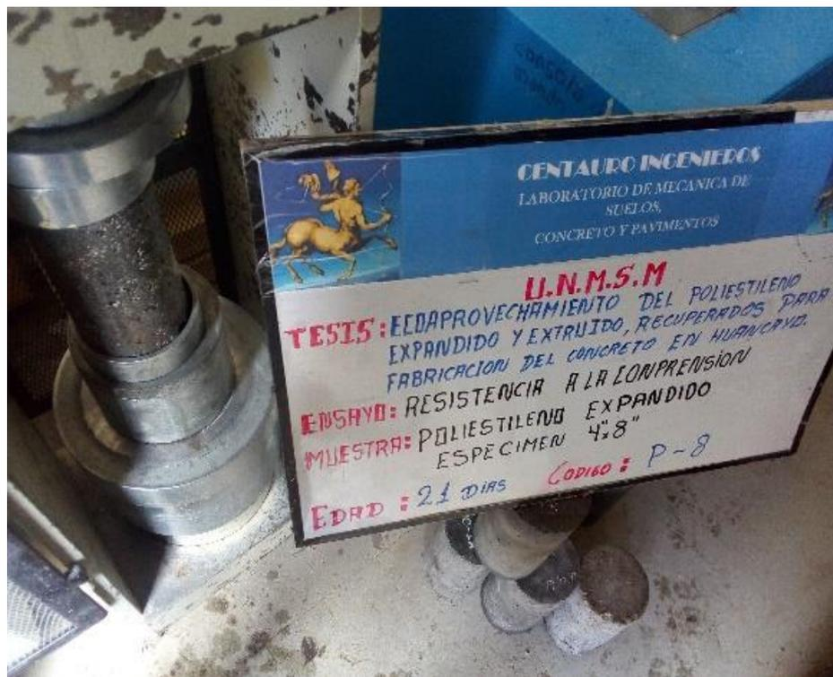
FIGURA 23: ESPÉCIMEN DE 4" x 8" DE 28 DÍAS PARA ENSAYO MECÁNICO DE RESISTENCIA - ASTM C39/C39M-12 – EPS
