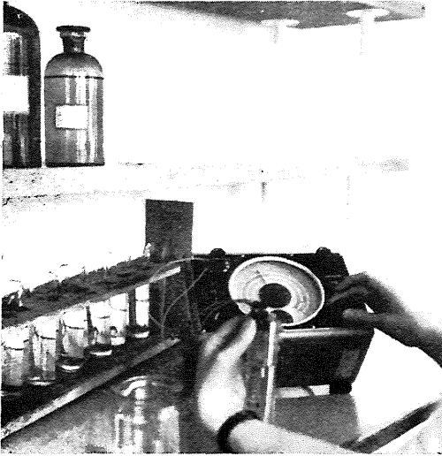
K u v a 10. Sähkönjohtokyky mitataan mittasillalla.
