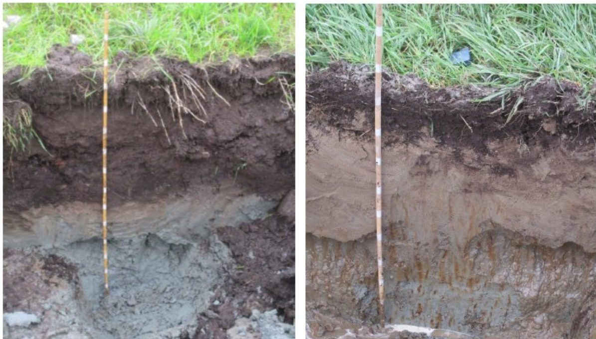
Kuva 5. Syväturpeisen ruudun 2 (vasemmalla) ja ohutturpeisen ruudun 5 (oikealla) maaprofiili. Huomaa eloperäisen maa-aineksen ja kivennäismaan jyrkkä raja varsinkin ruudulla 2. Kuvat: Markku Yli-Halla
