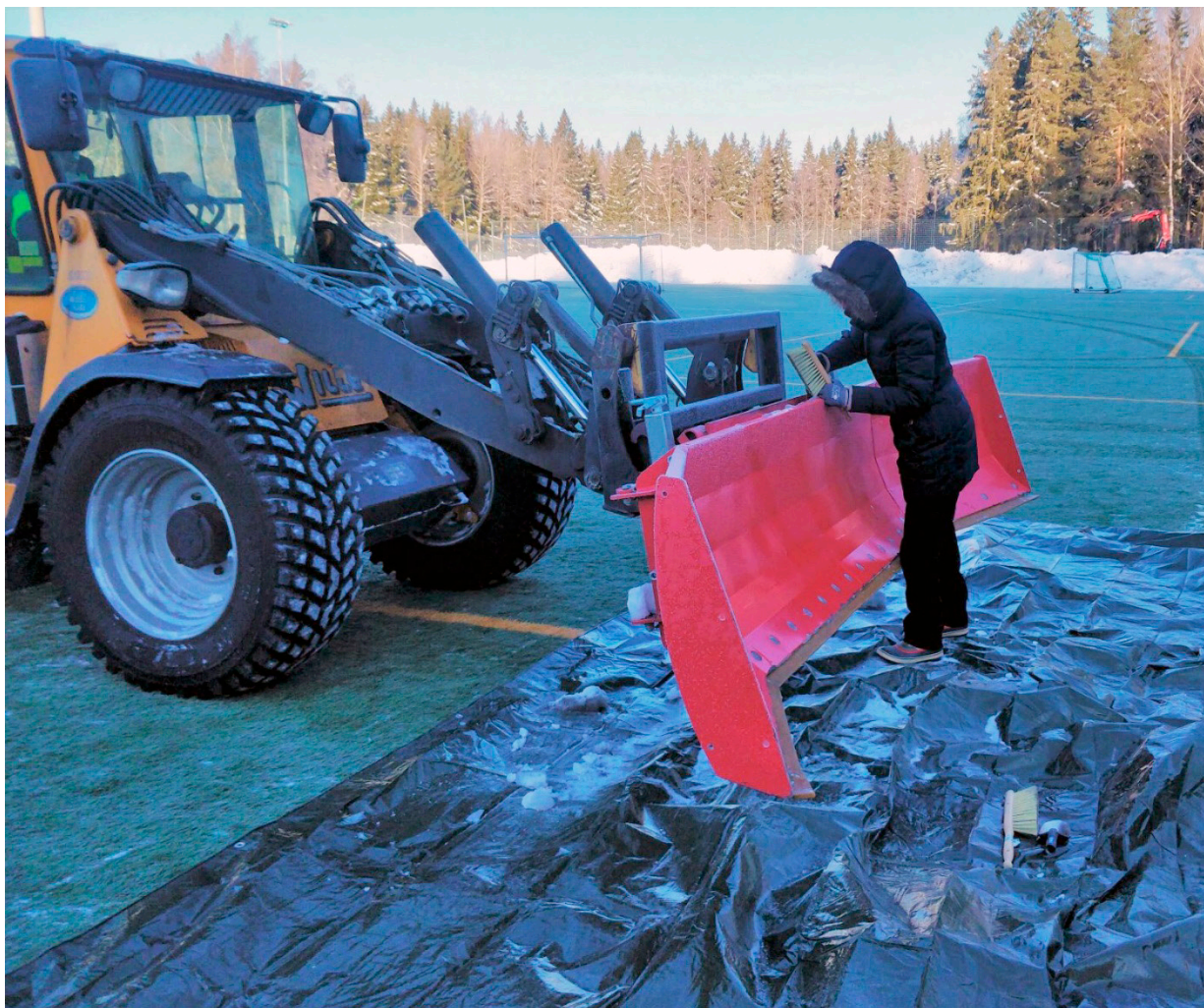
Kuva 17. Tekonurmikentän auraamisessa käytetty aura ja traktori. Kuva: Jyri Tirroniemi.
