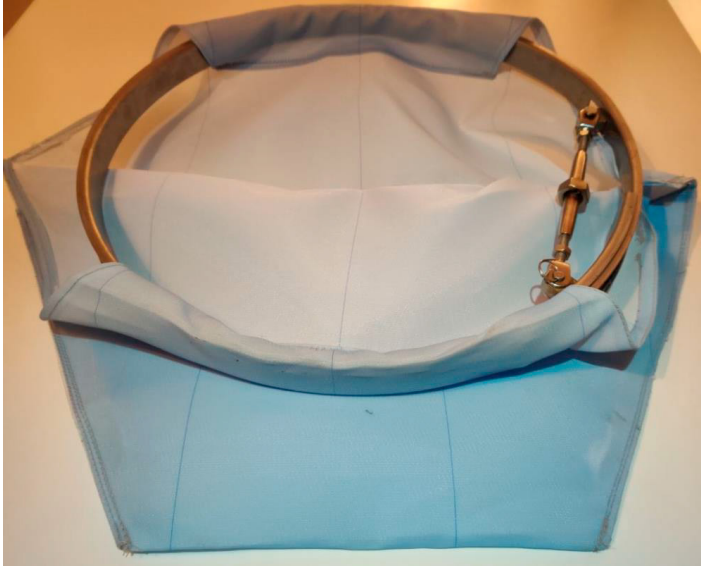
Kuva 2. Hulevesisuodatin, jonka pussiosa on valmistettu 0,1 mm reikäkoon viirakankaasta ja sen vedenvirtauskapasiteetti on 300 l/s/m 2 . Kuva: Wateco Oy
