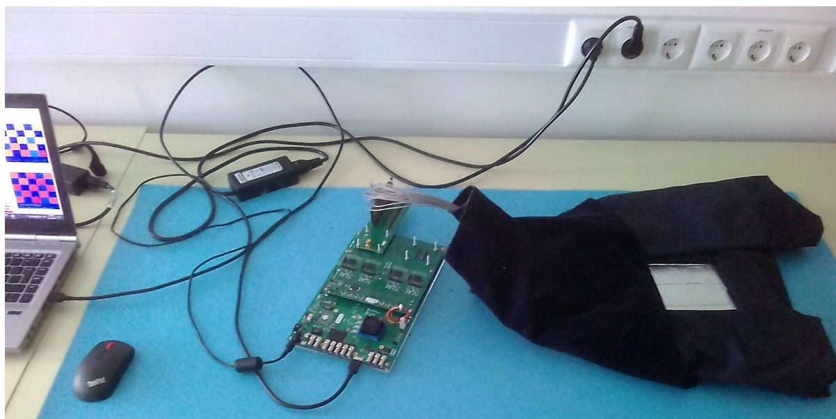
Joonis 4 20 mm stsintillaatorplaadiga detektor kasutuses. Vasakul servas on arvuti, millesse andmed kogusin. Keskel on vajalikud elektroonikakomponendid ja juhtmed. Paremalt on musta riidega kaetud detektor.
