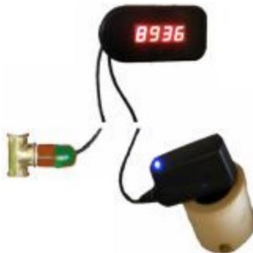
Рисунок 2.6 – Зовнішній вигляд пристрою попереднього технічного вимірювання гідродинамічного та температурного режиму потоку стічних
