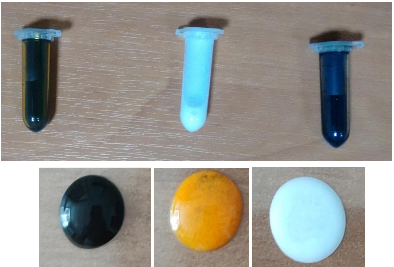
Рисунок 2.3 - Щойно синтезований розчин наночастинок \text{Cu}_2\text{ZnSnS}_4 , \text{ZnO} , \text{Cu}_2\text{ZnSnSe}_4 після заміщення поверхнево-активних речовин та краплі чорнил \text{Cu}_2\text{ZnSnS}_{4-y}\text{Se}_y , \text{CdS} , \text{ZnO} на підкладці
