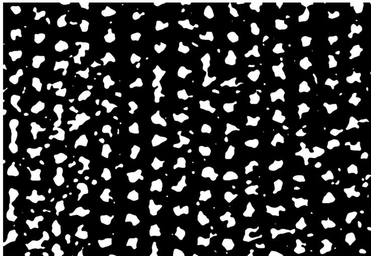
Figura 3.11: Imagem após a aplicação do filtro *threshold*, onde se pode visualizar com nitidez o formato e área dos buracos realizados. Este filtro permite então à análise e contagem dos buracos.
