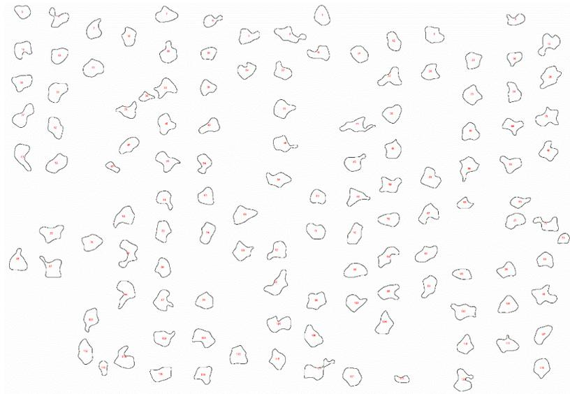
Figura 3.12: Resultado obtido através da ferramenta *analyse particles* do programa ImageJ. É apresentado todos os buracos que se encontravam dentro das áreas (567-2268)  $\mu\text{m}^2$  sendo excluídos os restantes.
