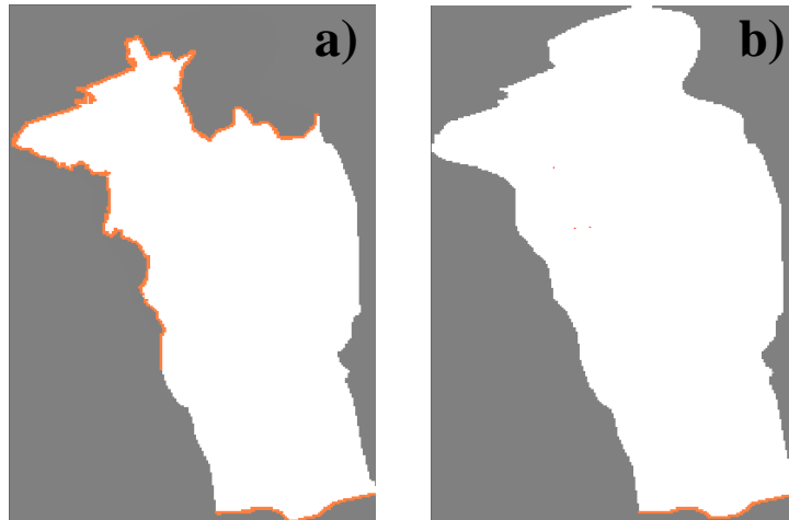
Figura 8.12: Condições de fronteira de massa impostas para o modelo de transporte de massa, sendo que as células a branco correspondem às de concentração ativas, as laranja às de concentração constante, e as cinzentas às de concentração inativa. a) aquífero livre e aquífero confinado; b) aquífero confinado.
