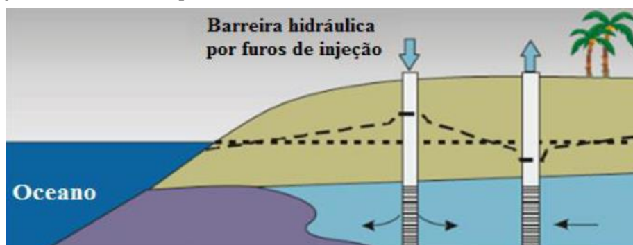
Figura 4.4: Representação esquemática de uma barreira hidráulica positiva gerada pela injeção artificial de água para limitar o avanço da intrusão salina em zonas costeiras (adaptado de JOHNSON, 2007. in ZEFERINO, 2016).
