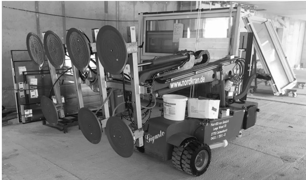
Abbildung 3.5: Manipulator oder Glasboy zum Einbringen der Verglasung in den Etagen 157
