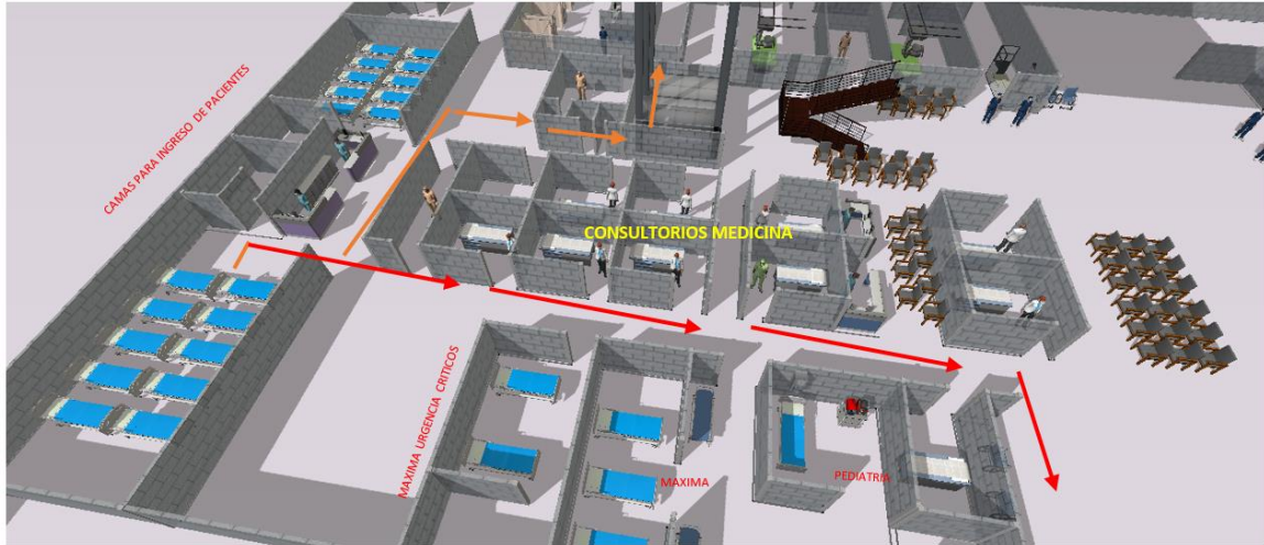
Fig. 3 En la gráfica (flexsim Healthcare 2022) se observa el flujo de paciente crítico rojo y naranja (toda la emergencia es una zona SIN movimiento de aire de forma mecánica). Se traslada del área de observación o también llamada medicina observación, la flecha roja indica el recorrido pasa por el pasillo donde circula pediatría, médicos, personal de limpieza enfermeras, pacientes que aparecen de los consultorios y es dirigido hacia la ambulancia, o es llevado al quinto nivel o es trasladado a la morgue que se encontraba en el primer nivel por el ascensor.
