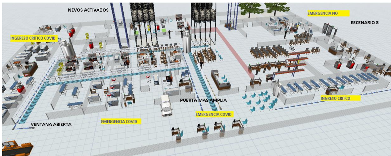
Escenario. 3 (flexsim Healthcare 2022) Se cambió la posición de ambas emergencias agregando consultorios y camas en espacio abierto, además se abrió ventanas y puertas permitiendo el viento que viene del norte atraviese los pasillos de la emergencia movilizand el flujo de aire, se habilito los vanos para el flujo de aire cruzado.
