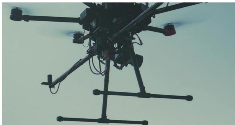
Figura 27. *Dron equipado con sistema IMU (detrás de la cámara) y una pértiga para las antenas GPS*
