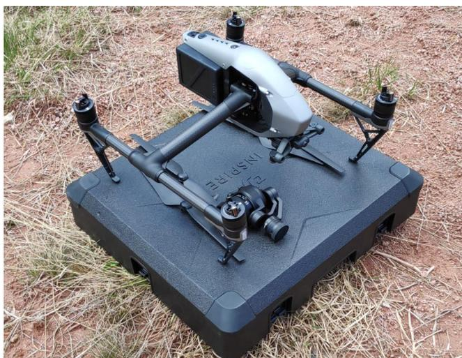
Figura 4. Dron Inspire 2 y cámara Zenmuse X5S, antes de montar las hélices, y el gimbal con la cámara
