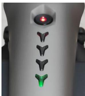
Figura 51. Botón de encendido del dron y luces de estado
