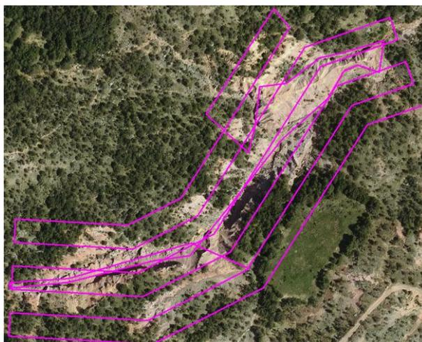
Figura 16. Líneas de vuelo paralelas (20 metros de separación), y recorrido de ida y vuelta sobre la zona de interés del torrente
