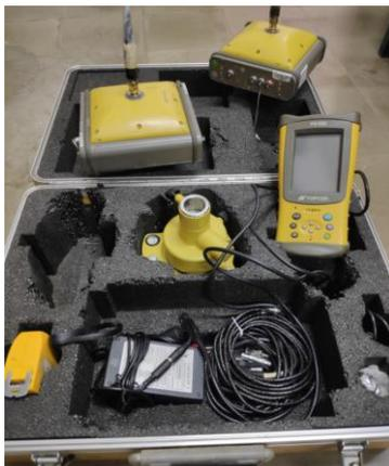
Figura 3. Conjunto de receptores GPS utilizados
