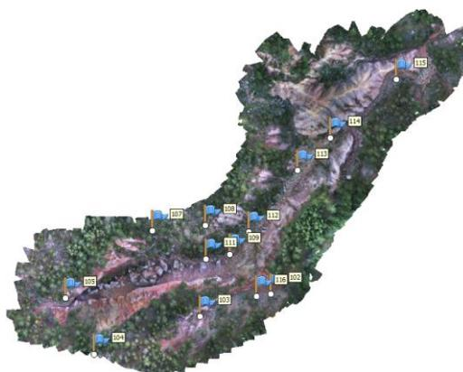
Figura 7. *Distribución de puntos de apoyo en el vuelo del 20 de nov. de 2020*
