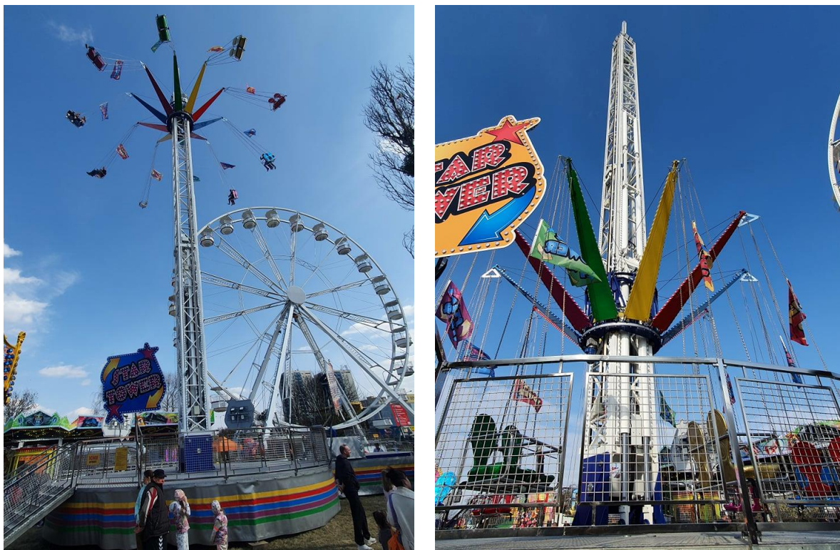
Obr. 1 – Swing tower – vlevo v provozním stavu, vpravo ve stavu připraveném pro provoz
