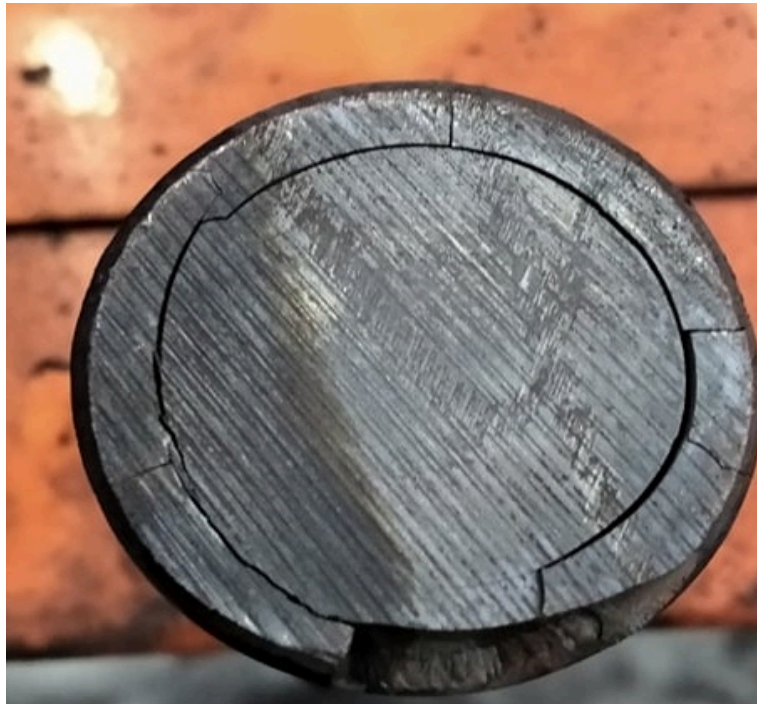
Obr. 14 Kalicí trhliny na konci tyče.
