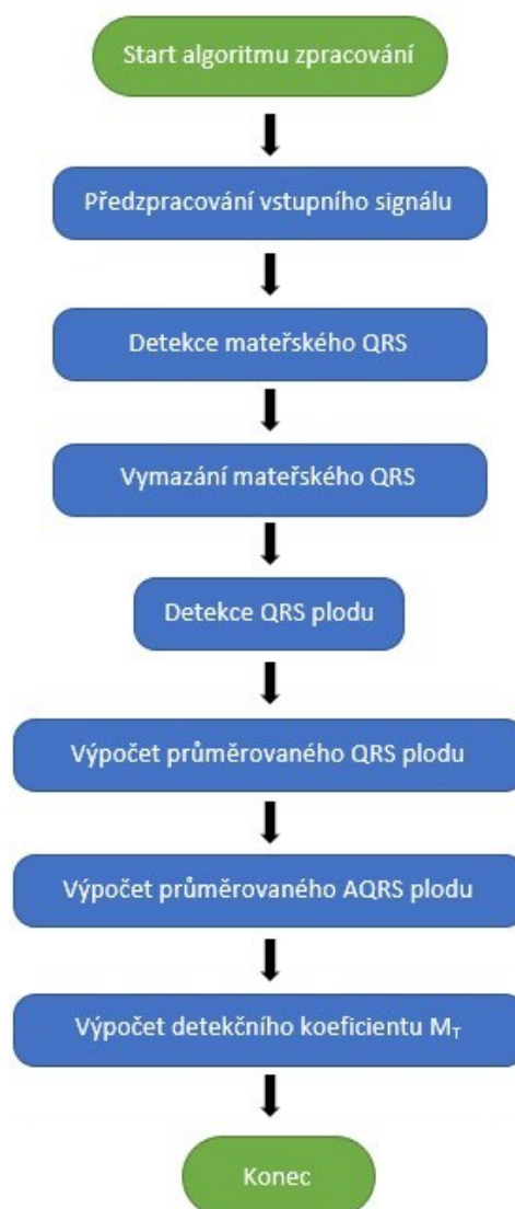
Obrázek 44: Vývojový diagram detekce pohybu plodu vlivem změn amplitudy f_{QRS}
