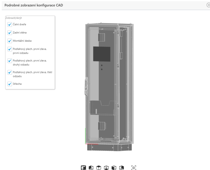
Obr. 26 Výsledný návrh rozvaděče softwaru RiPanel
