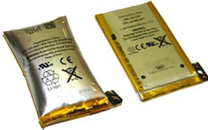
Obrázek 7 – ukázka nabobtnání pouzdrového článku [19]
